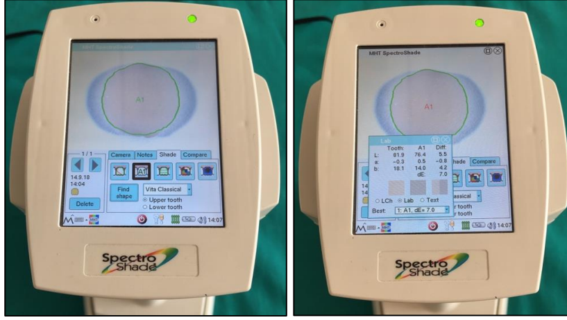
Şekil 3.10. Spektrofotmetre cihazı ile ikinci renk ölçümlerinin yapılması
