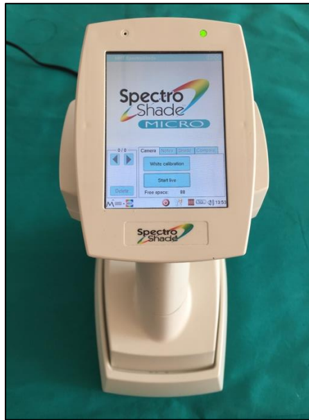
Şekil 3.6. Örneklerin spektrofotometre cihazı ile renk ölçümlerinin yapılması
