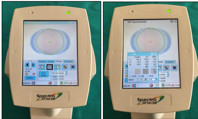
Şekil 3.8. Spektrofotometre cihazı ile ilk renk ölçümlerinin yapılması
