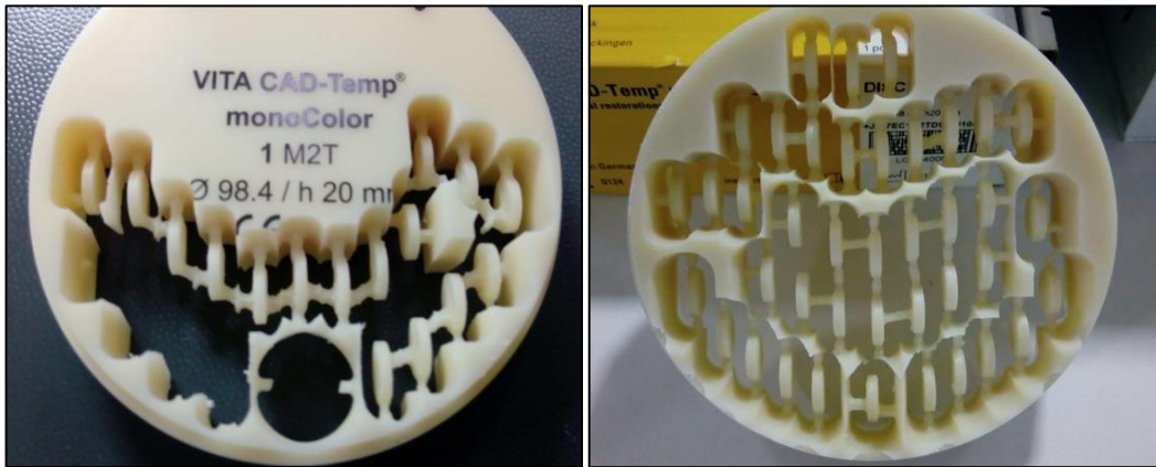
Şekil 3.3. CAD-CAM cihazı ile disklerin freze edilmesi
