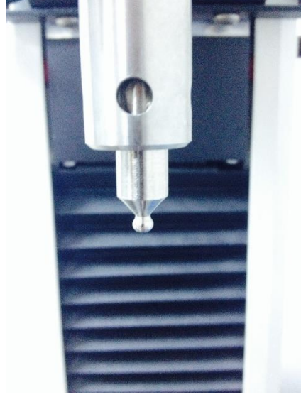
Şekil 3.9. Çalışmamızda kırma testi için kullanılan 3,6 mm çapa sahip küre şeklindeki paslanmaz çelik uç
