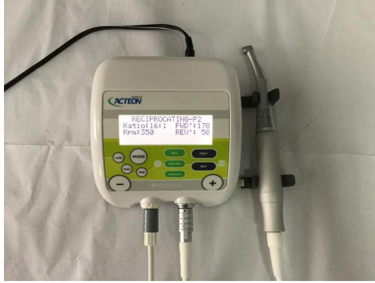
Şekil 2.23. Satelec Endodual motor ve resiprokal hareket programı SY 170°-SYT 50°
