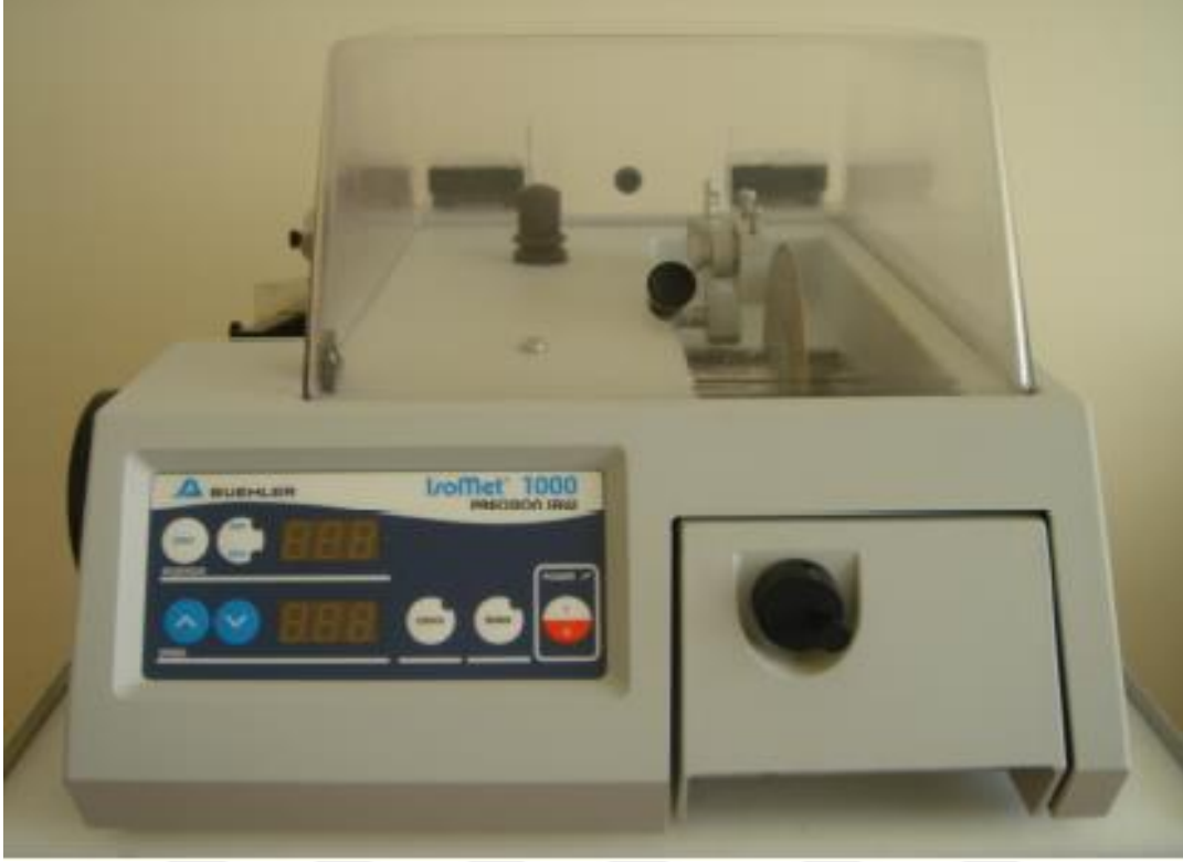
Şekil 3.2: Isomet su soğutmalı kesme cihazı
