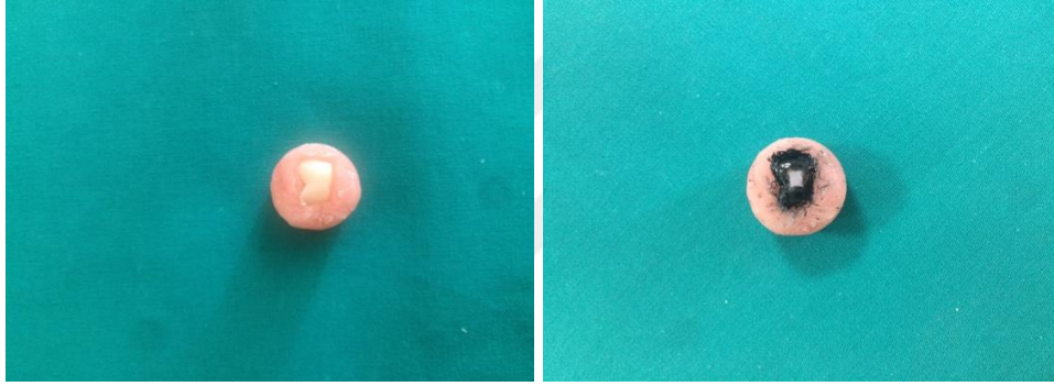
Şekil 3.1. Örneklerin akriliğe gömülmesi ve ajan uygulanacak yüzeylerin hazırlanması
