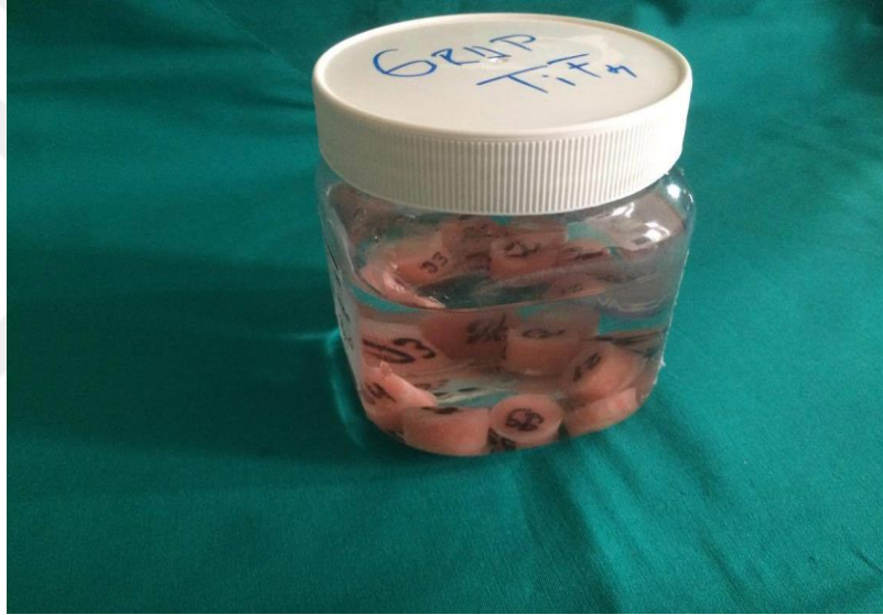
Şekil 3.5. Örneklerin re-demineralizasyon solüsyonunda bekletilmesi
