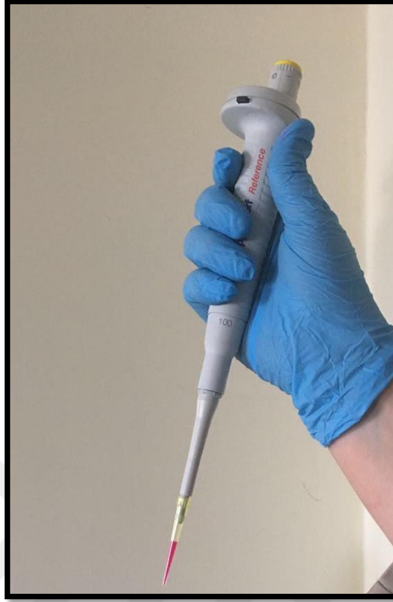
Şekil 3.6. Kullanılan pata Rhodamine B ilave edilirken kullanılan mikrolitre ölçüm cihazı
