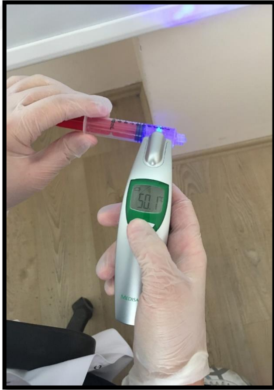
Şekil 3.5. Enjektör sıcaklıklarının ölçümü
