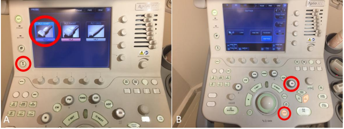
Şekil 3.5. USG cihazında prob seçimi ve görüntü ayarları. A. Ana panelde prob seçme tuşu ve dokunmatik panelde 12-MHz lineer transdüser prob seçimi, B. Ana panelde seçilmiş olan 2D gösterim modu ve Q-SCAN tuşu
