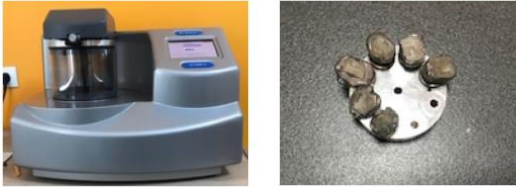
Şekil 3.18. Altın kaplama cihazı ve altın kaplama işlemi tamamlanmış örnekler
