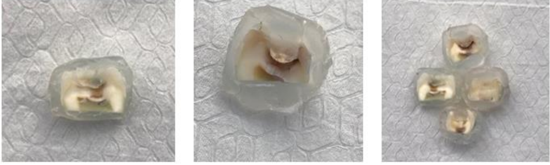
Şekil 3.17. SEM-EDS ölçümü için hazırlanmış örnekler
