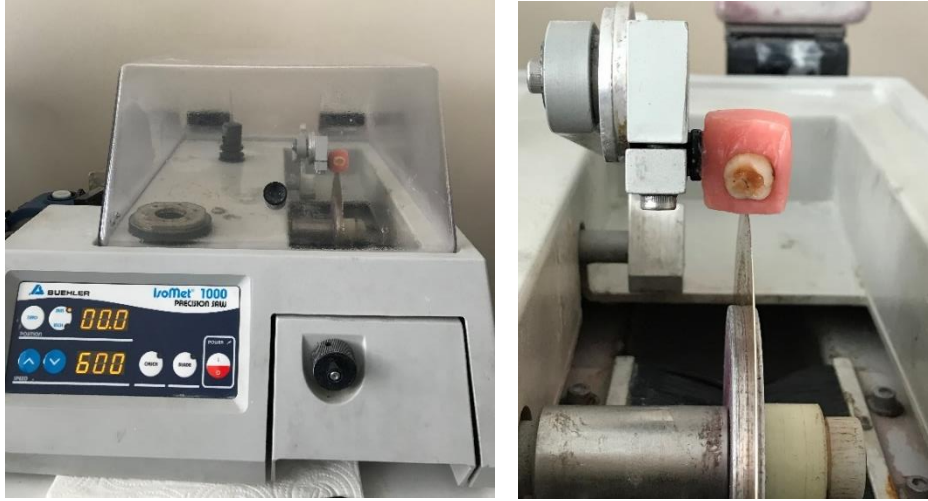
Şekil 3.10. İsoMet cihazı ve çürük uzaklaştırma yöntemlerinden biri uygulanmış olan örneğin bukko-lingual olarak ikiye ayrılması
