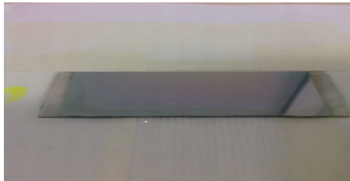
Őekil 5.20. Elde edilen magnezyum elementinin ince filminin fotoęrafı
