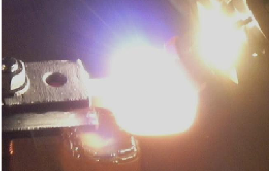
Şekil 4.7. Termiyonik vakum ark (TVA) sisteminde bor’ un plazması
