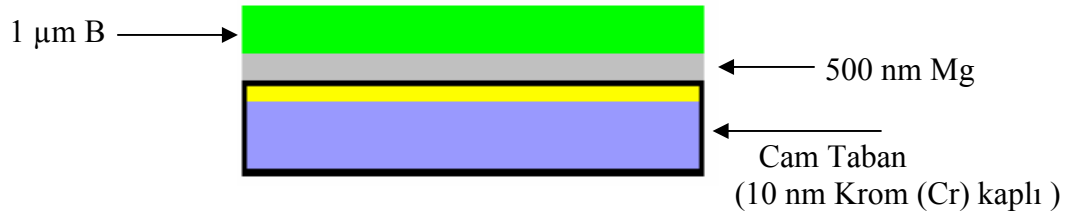
Şekil 5. 27. MgB 2 ince filmin I. katman (magnezyum), II. katman (bor) ‘ lı yapısı
