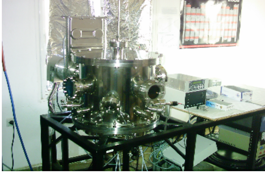
Şekil 5. 30. İzmir Yüksek Teknoloji Enstitüsü (IYTE)' de bulunan doğru akım(DC) magnetron saçtırma sistemi
