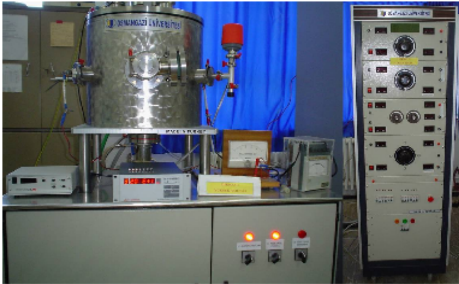
Şekil 4.6. Düşük erime sıcaklığına sahip materyaller için termiyonik vakum ark (TVA) sisteminin fotoğrafı
