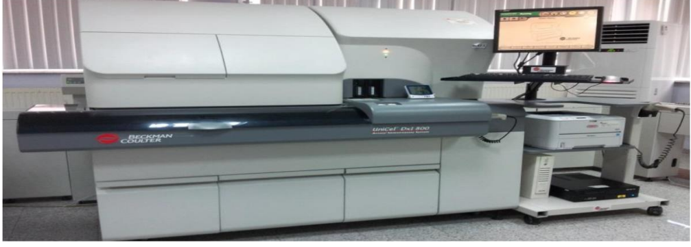
Şekil 9: Beckman Coulter DXI 800 Cihazı (USA) (kortizol seviyelerinin ölçüldüğü cihaz)
