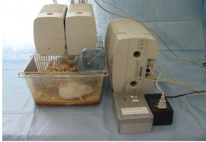
Resim 2: Farelere akustik travma uygulanan düzenek
