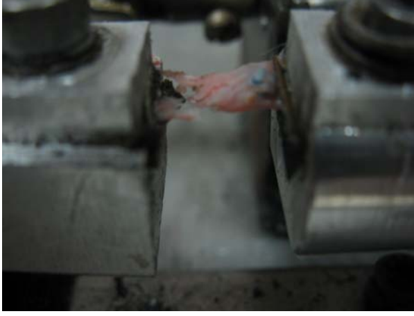
Şekil 19: Germe düzeneğinde tendonun kopma anı
