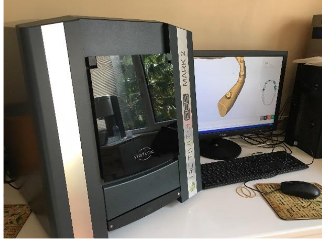
Őekil 3.7. Activity 885 Mark 2 Scanner ile gerekleřtirilen referans model taraması
