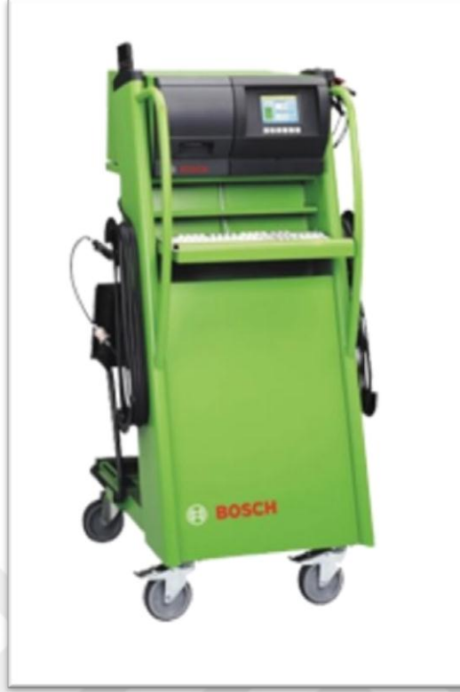
Şekil 8.10. BOSCH BEA350 Egzoz Gazı Emisyon Test Cihazı
