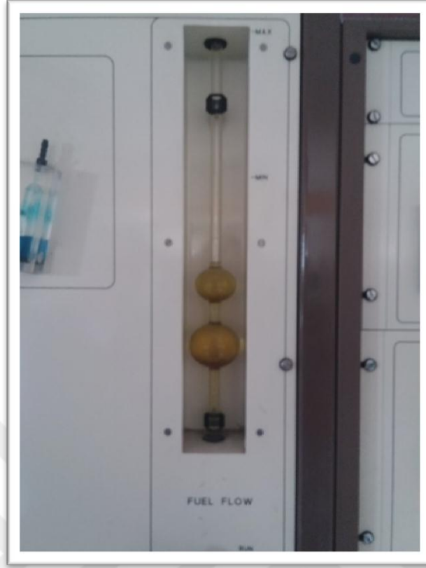
Şekil 9.14. Tüketilen Benzinin Hacimsel Miktarının Ölçülmesi
