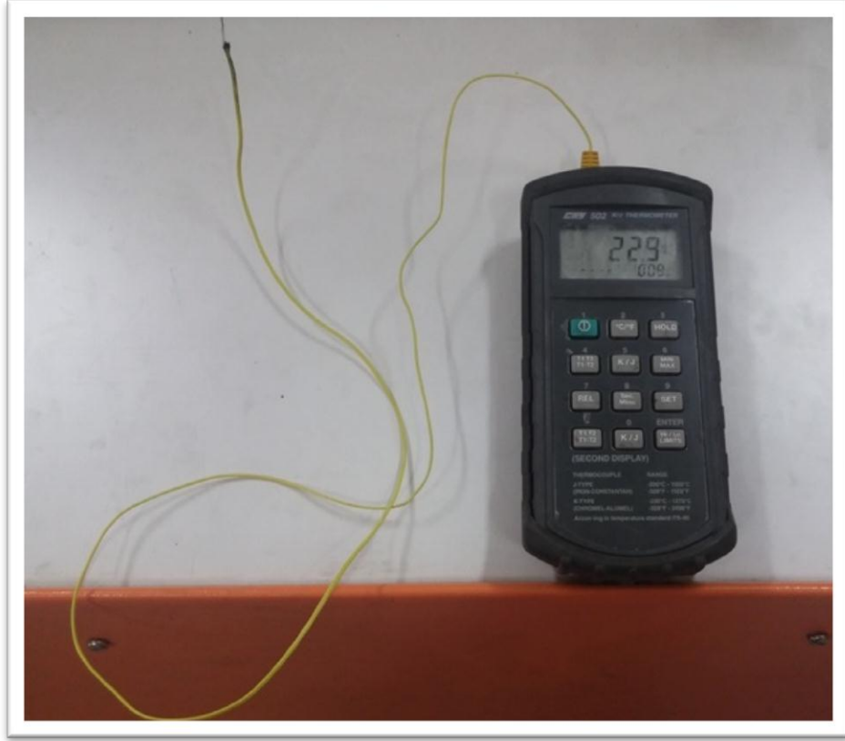
Şekil 8.7. CHY 502K/J Isıl Çift Donanımlı Dijital Termometre
