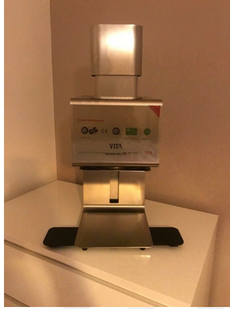
Şekil 3.6. Vacumat 6000 MP porselen fırını
