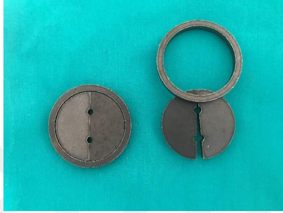
Şekil 3.5. Basma dayanımı testi için kullanılan metal kalıplar
