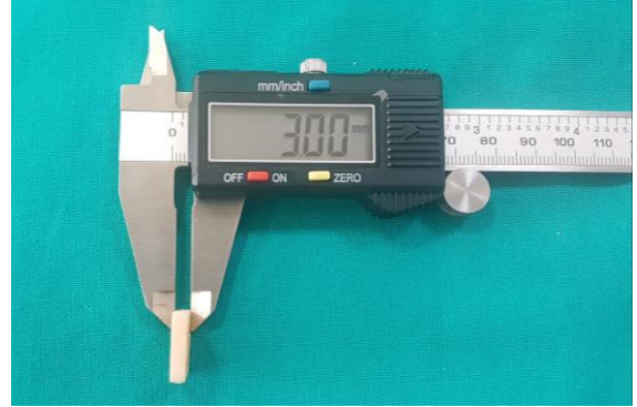
Şekil 3.28. Aşınma direnci testi için örneklerin kalınlığının ölçümü
