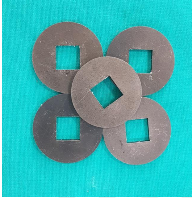
Şekil 3.18. Aşınma direnci testi için kullanılan metal kalıplar
