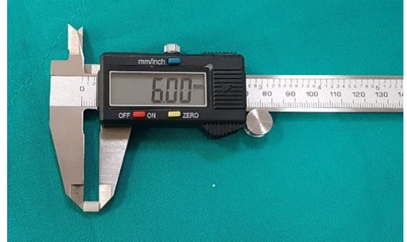
Şekil 3.15. Basma dayanımı testi için örneklerin boyunun ölçümü
