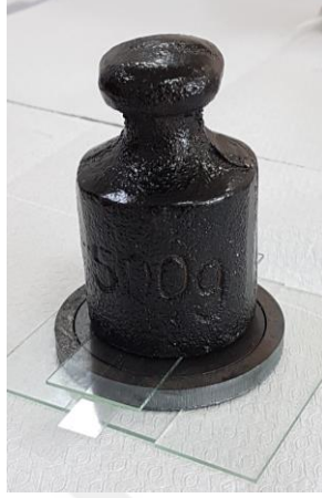
Şekil 3.1. 0.50 kg ağırlık uygulaması
