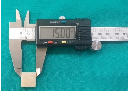
Şekil 3.27. Aşınma direnci testi için örneklerin boyunun ölçümü
