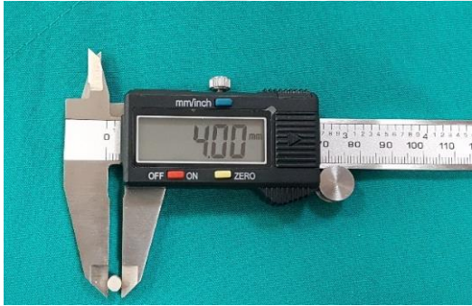
Şekil 3.14. Basma dayanımı testi için örneklerin çapının ölçümü
