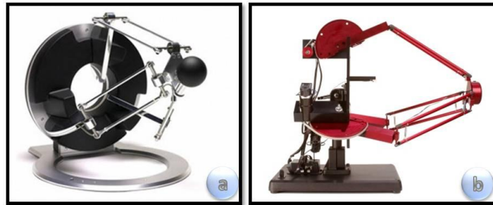
Şekil 2.8 Paralel mekanizmalı haptik cihazlar
