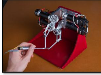
Şekil 2.9 Hibrit mekanizmalı bir haptik cihaz [23]
