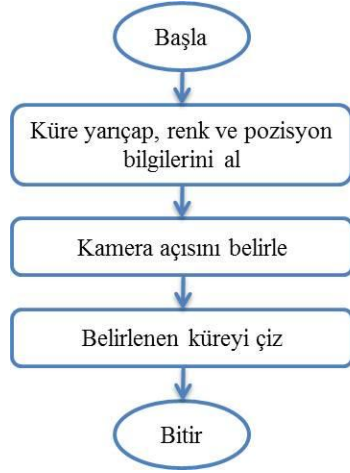
Şekil 3.19 Kure_Ciz fonksiyonu akış diyagramı, algoritma ve kod yapısı
