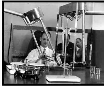
Şekil 2.5 Master-slave sistem (Goertz, 1951) [15]
