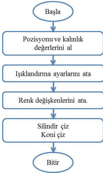
Şekil 3.22 Kuvvet_Vektoru_Ciz fonksiyonu akış diyagramı, algoritma ve kod yapısı
