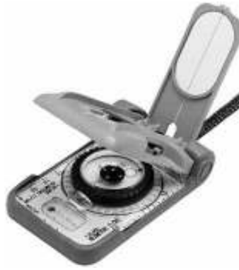
Şekil 2.3 Prizmatik teodolit pusula
