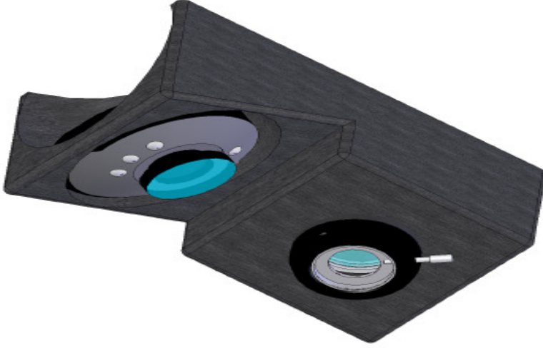
Şekil 5: Deneysel crosslinking cihazının alttan görünümü, CMOS kamera (sol), iris diyafram (sağ)
