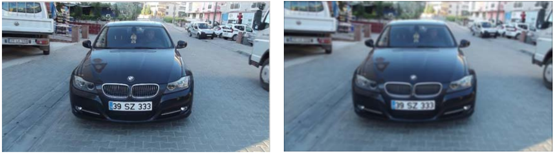
Şekil 3.16: Gürültülü görüntü ve Ortalama filtre uygulanmış hali
