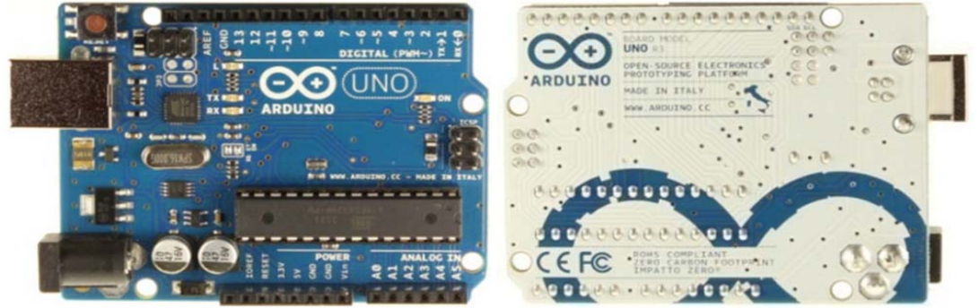
Şekil 3.2: Arduino Uno Mikroişlemci Kartı (Ön ve Arka Yüzü)
