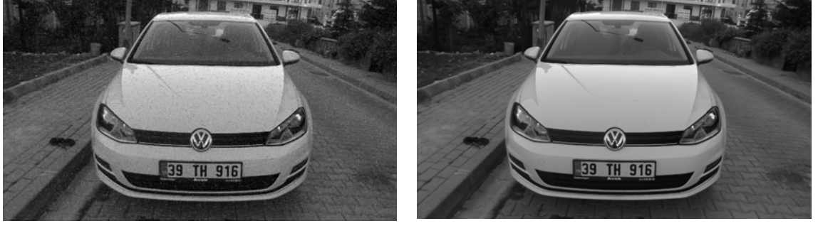
Şekil 3.15: Gürültülü görüntü ve Medyan filtre uygulanmış hali
