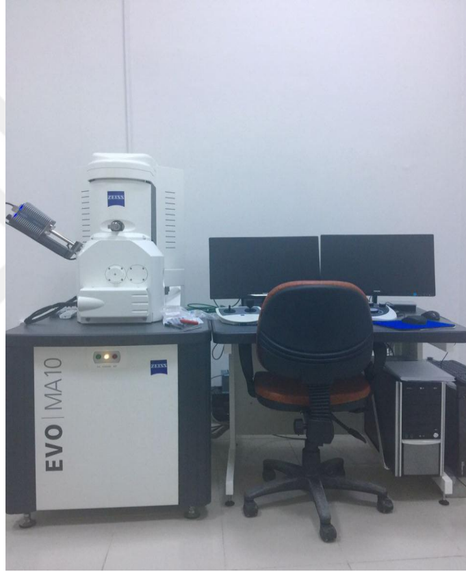
Őekil 5.7. SEM ve EDX Analizlerinin Yapıldıđı Taramalı Elektron Mikroskobu
