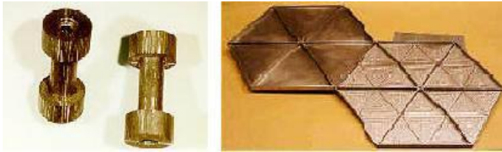
Şekil 3.6. Karbon fiber katkıli Mg matrisli kompozit uydu destek parçaları
