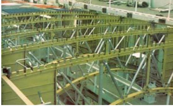
Şekil 3.4. Uzay mekiği gövdesinde kullanılan bor fiber takviyeli alüminyum tüpler
