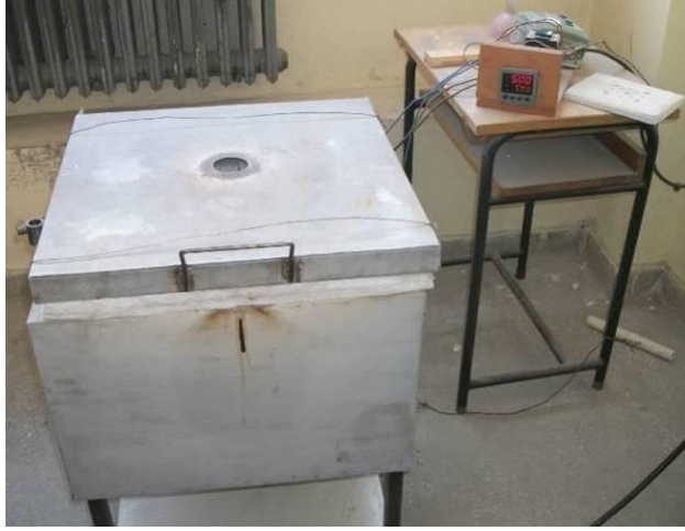
Şekil 5.4. Ergitme fırını imalat resmi
