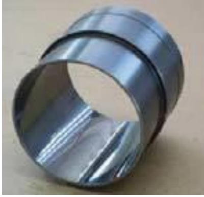
Şekil 3.2. SiC partikül takviyeli Al
