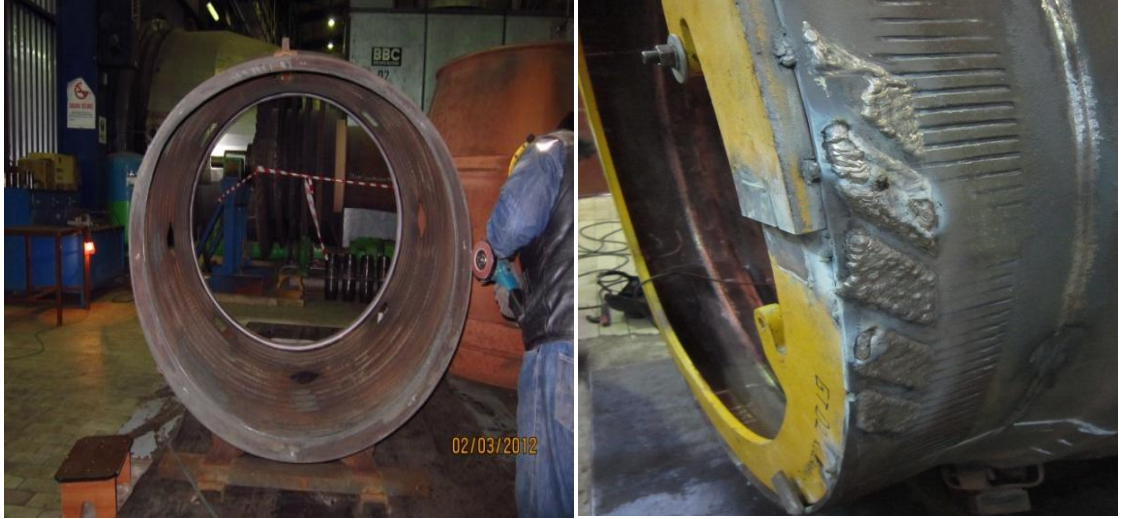
Şekil 6.18. (a) İç Tüp Çapta Oluşan Deformasyon (b) Tamir Segmanı
