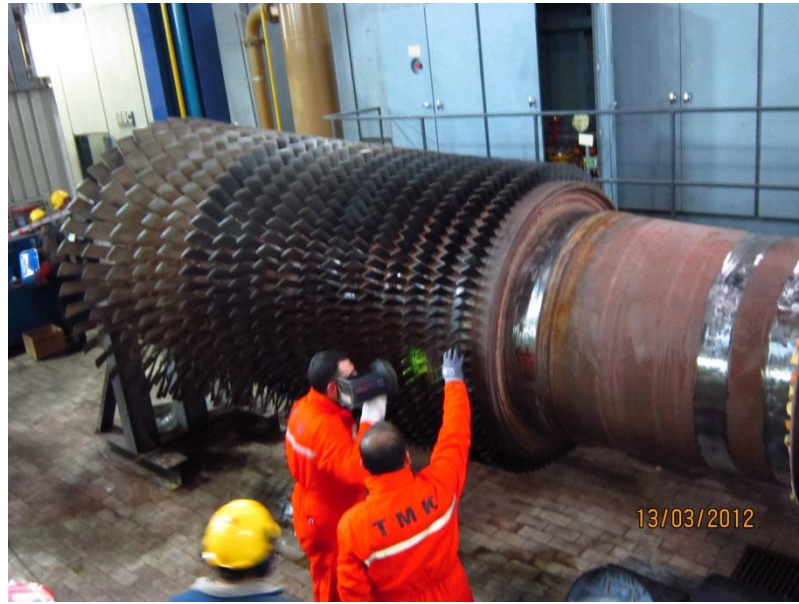
Şekil 6.38. Kompresör Hareketli Kanatlara Floresan Testinin Yapılması
