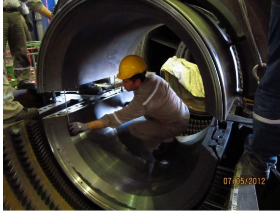
Şekil 6.53. Kompresör Difüzörü Ölçülerin Alınması
