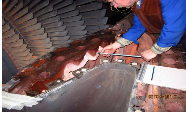
Şekil 6.27. Türbin Sabit Kanat Taşıyıcıdan Ölçüm Alınması
