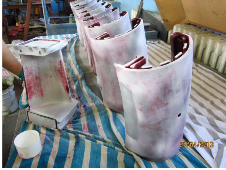
Şekil 6.49. Sabit Kanat ve Giriş Zırhlarının Penetran İle Muayenesi
