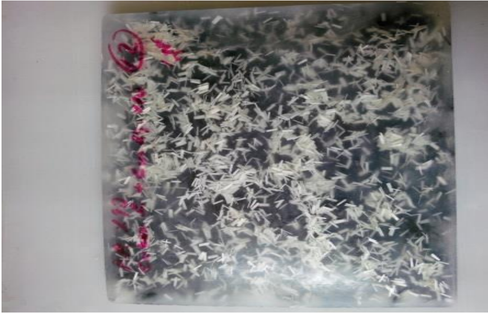
Şekil 4. 12 12 no'lu parça (PP %90+Karbon Elyaf %5(5mm)+Cam Elyaf %5(5mm))
