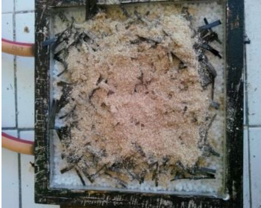
Şekil 4. 8 Karbon elyaf ve odun tozu karışımı (21 no'lu parça)
