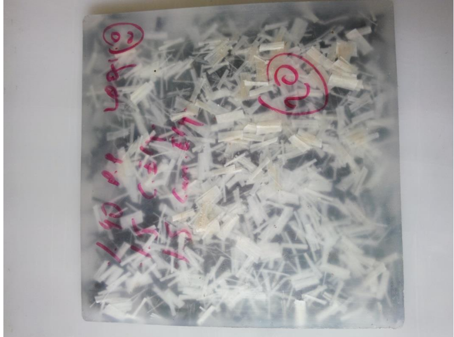
Şekil 4. 10 20 no'lu parça (Karbon Elyaf %5 (20mm) + Cam Elyaf %5 (20mm))
