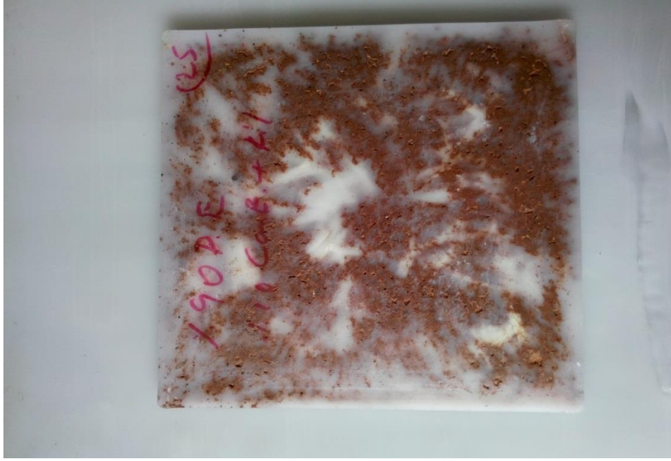
Şekil 4. 13 25 no'lu parça (Cam Elyaf %6,6 (20mm) + Kil Tozu %3,3)
