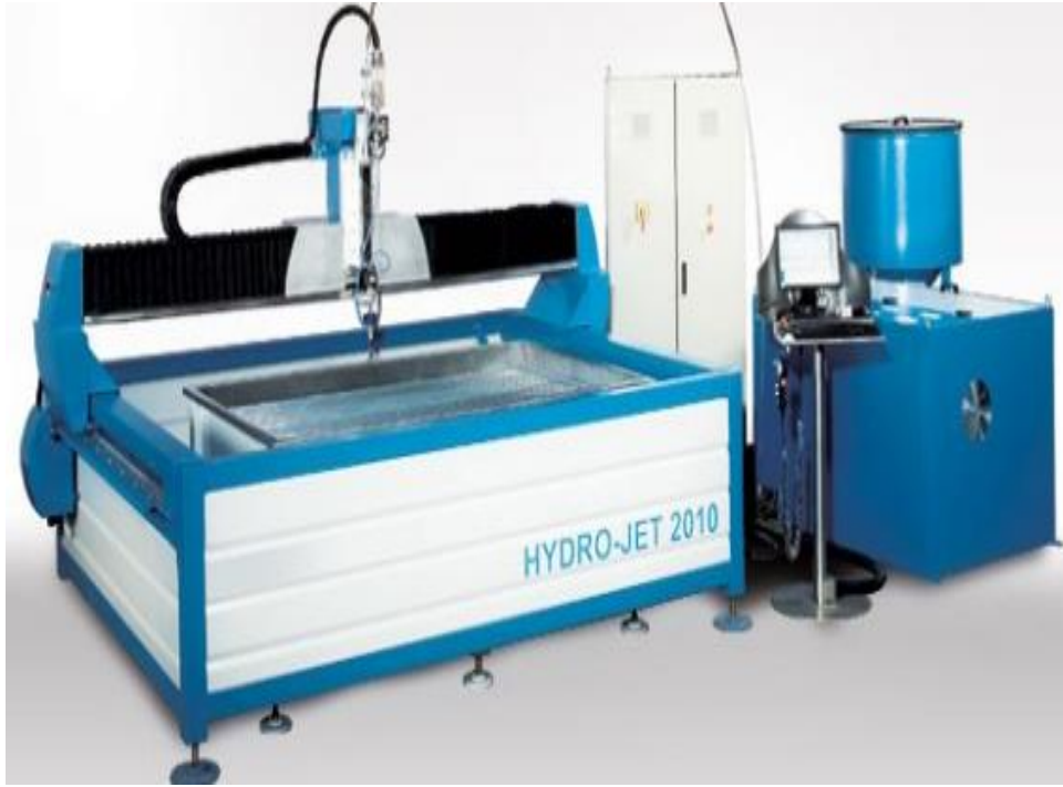
Şekil 4. 21 Numunelerin kesildiği su jeti cihazına ait resim
