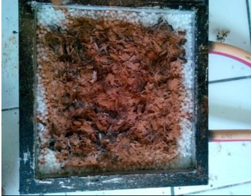
Şekil 4. 4 Cam Elyaf, Sabun tozu, Karbon elyaf, Kil tozu ve Odun tozu karışımı (18 no'lu parça)
