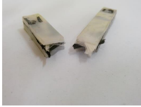
Şekil 5. 16 Parça-19 (PE %90 + Cam Elyaf %5 (20mm)+ Karbon Elyaf %5 (20mm) Karışımı)
