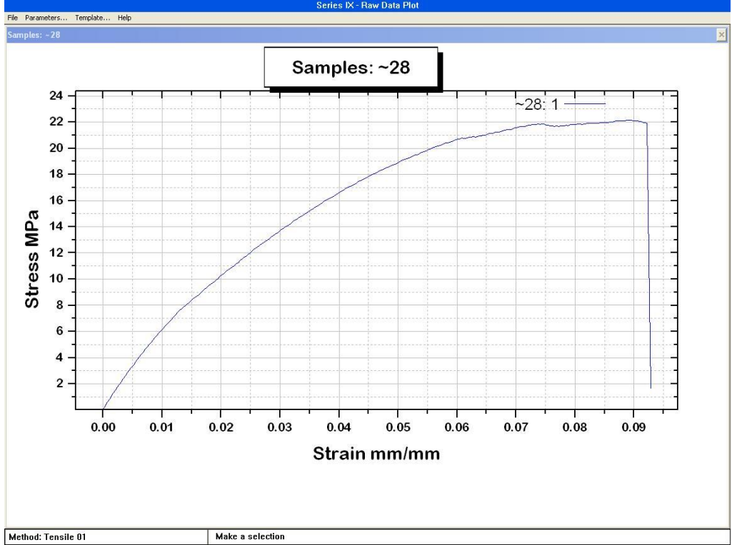
Şekil 5. 13 Parça-28 ( PP %90+ EPDM %5+Cam Elyaf %5 (20mm) Karışımı )
