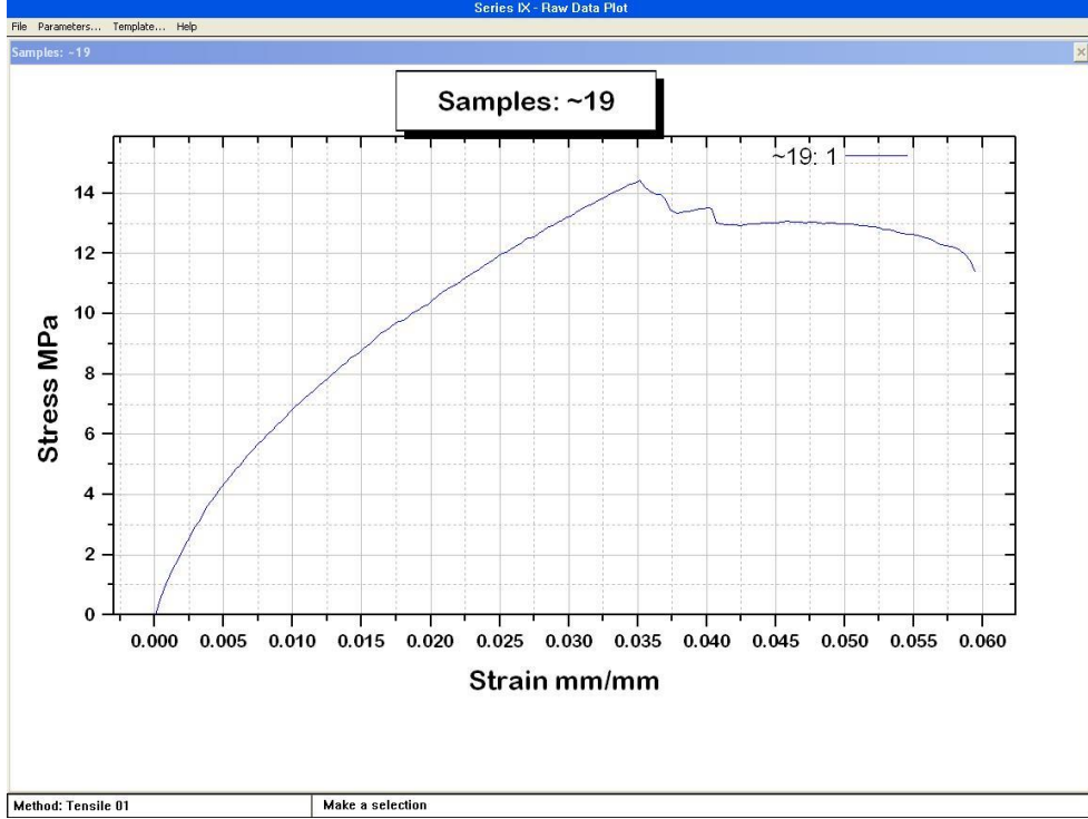
Şekil 5. 5 Parça-19 (PE %90 + Cam Elyaf %5 (20mm)+ Karbon Elyaf %5 (20mm) Karışımı)
