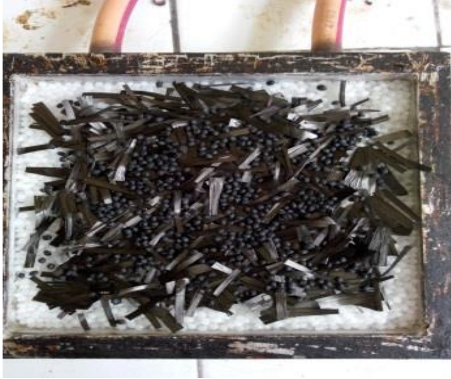
Şekil 4. 7 Karbon elyaf Epdm karışımı (29 no'lu parça)
