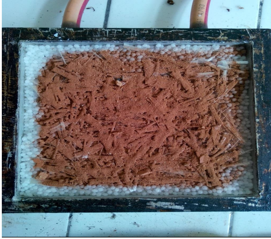
Şekil 4. 5 Cam elyaf ve kil tozu karışımı (25 no'lu parça)
