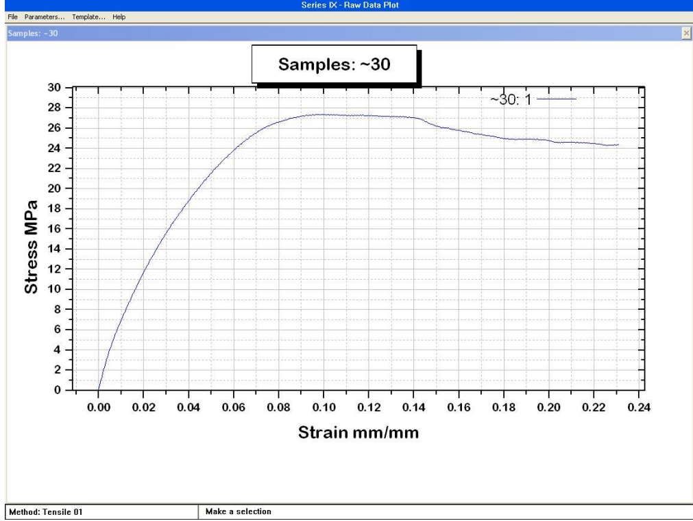
Şekil 5. 15 Parça-30 ( PP %90+ EPDM %5+ Karbon Elyaf %5 (20mm) Karışımı)
