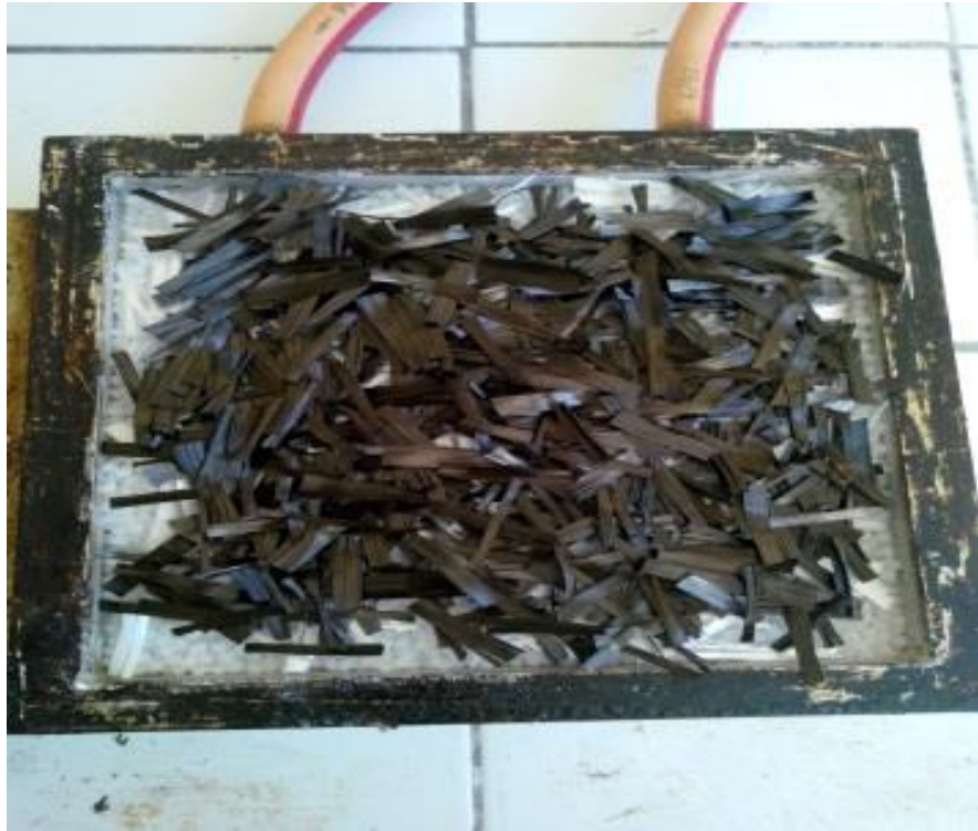
Şekil 4. 6 Karbon elyaf ve Cam elyaf karışımı (20 no'lu parça)
