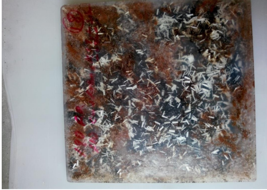
Şekil 4. 9 18 no'lu parça ( Cam Elyaf %2 (5mm) + Karbon Elyaf %2 (5mm) + Odun Tozu %2 + Kil Tozu %2 + Sabun Tozu %2)
