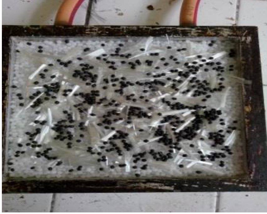
Şekil 4. 2 Cam Elyaf EPDM karışımı (27 no'lu parça)
