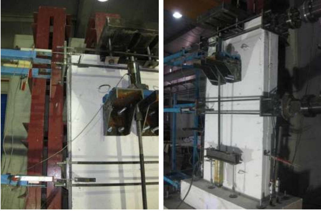
Şekil 6.2. Perdenin çerçeveden ayrılmaya başlaması
