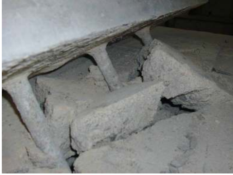
Şekil 4.3. Numunelerin çıkarılmasında oluşan hasar
