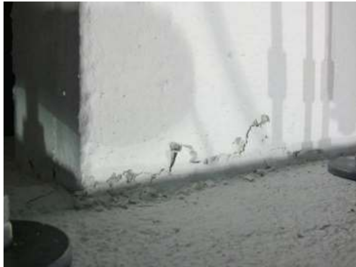
Şekil 6.17. C3DA+ elemanında basınç bölgesinde ezilme başlangıcı
