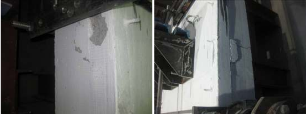
Şekil 6.18. C3DD elemanında perde ve çerçeve konik kopmaları
