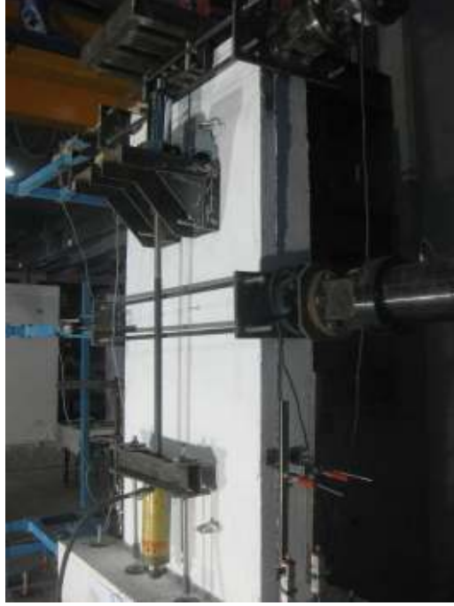
Şekil 6.8. Kiriş ankraj oranı %0 olan çerçevelerin dış perdeden ayrışması
