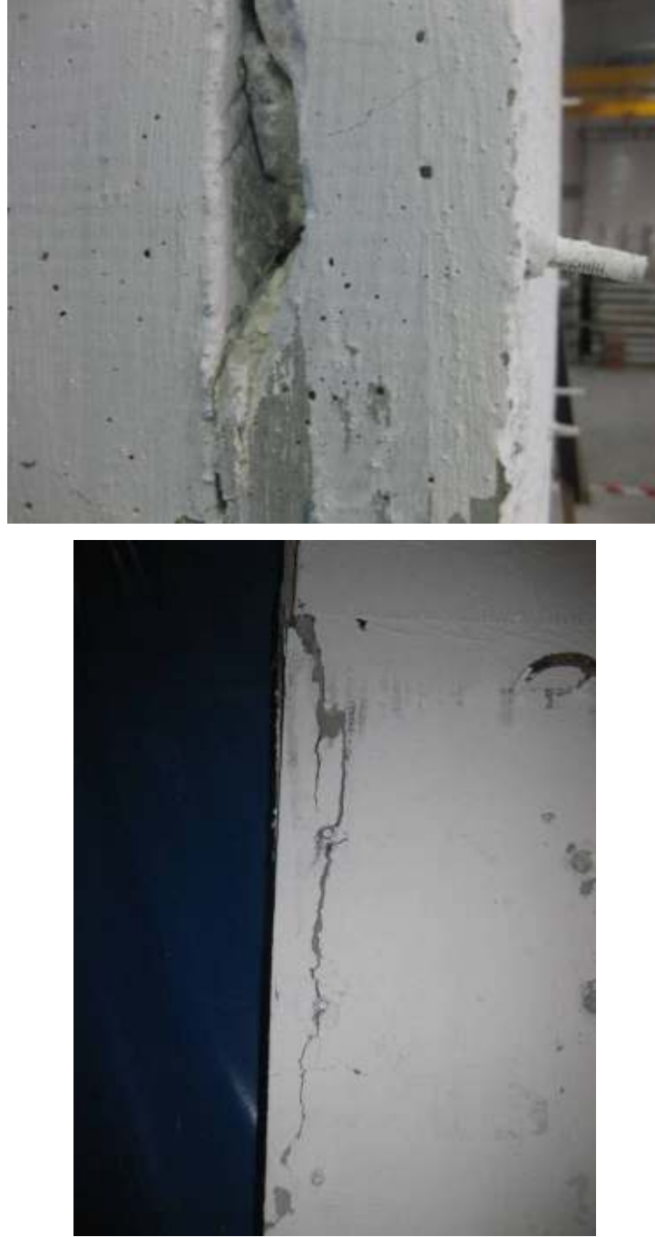
Şekil 6.13. C3 çerçevelerde konik kopmalar
