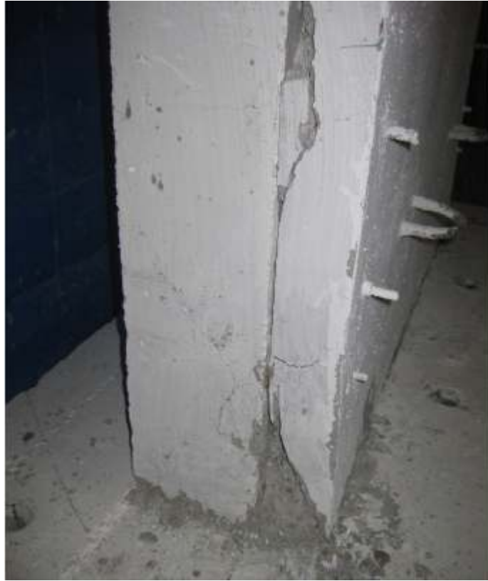
Şekil 6.15. C3BB elemanında tabanda kayma
