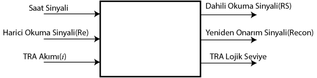
Şekil 4.1 Sonlu durum otomatı blok diyagramı.
