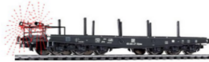
b) İki diyagonal tarayıcıya sahip flatcar'ın şematik diyagramı
