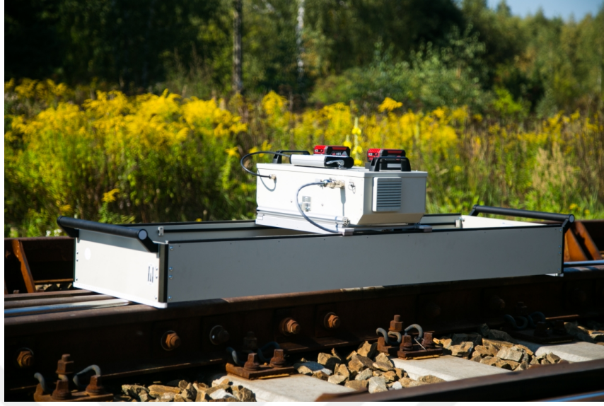
Şekil 2.16. Ray ve dönüş profili ölçümü için 3D lazer tarama sistemi [71-73].
