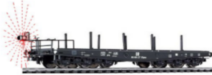
a) Flatcar'ın tek bir profil tarayıcısına ait şematik diyagramı
