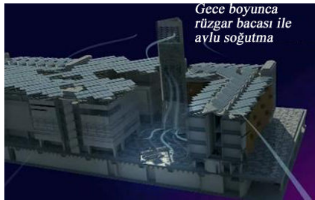
Şekil 4.30. Pasif havalandırma yöntemi rüzgâr bacası ile soğutma
