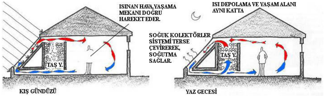
Şekil 3.9. Taş yataklamanın güneş kolektörleri ile çalışma prensibi (URL-13)
