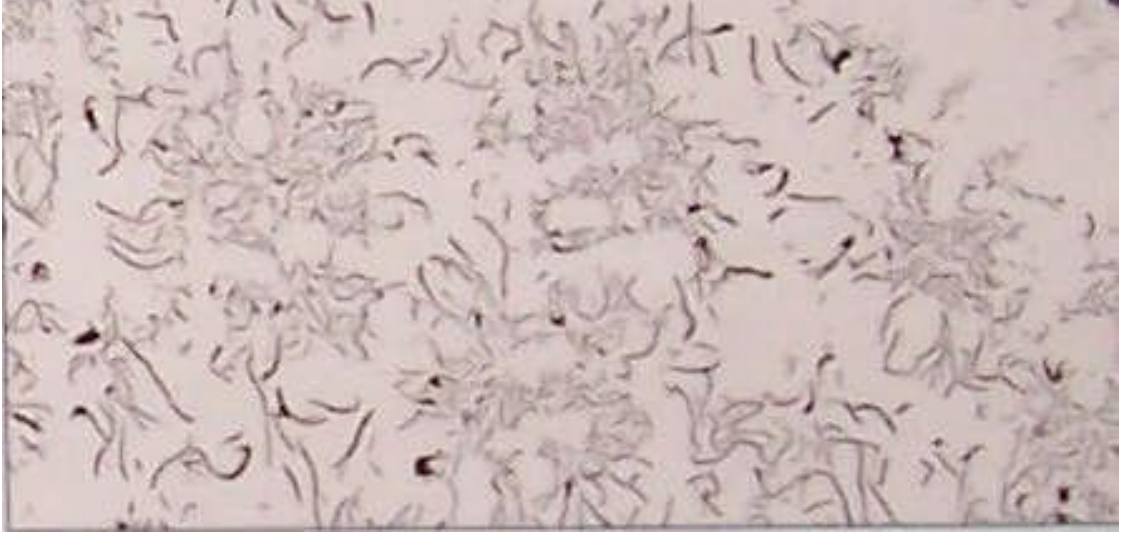
Şekil 2.1. Grafitin gri dökme demir yapısındaki dağılımı [1]
