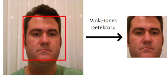
Şekil 3.6 Görüntünün Viola-Jones detektörü ile tespit edilerek kırılması
