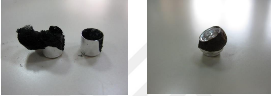
Şekil 8. 6. Melasın DTA/TG analizleri esnasında oluşan görüntü
