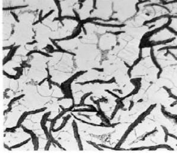
Şekil 2. 24. Gri dökme demirin mikro yapısı (URL-15, 2018).
