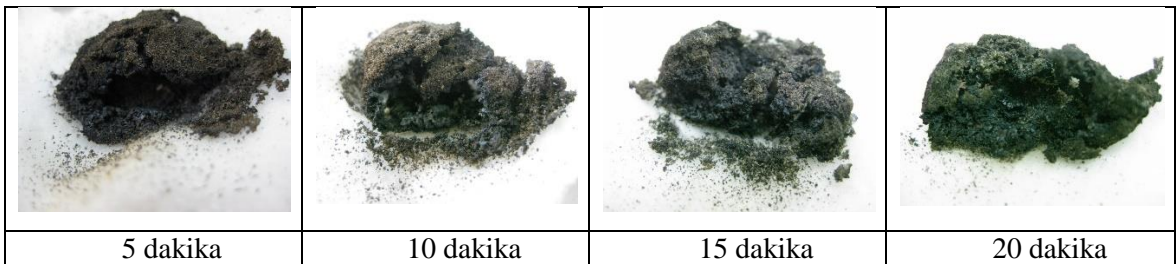
Şekil 8. 116. -150 +106 \mu\text{m} tane boyutundaki konsantreden hazırlanan kompozit peletlerin farklı redüksiyon süreleri sonunda makro görüntüleri
