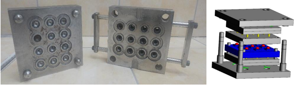
Şekil 8. 10. Peletleme işlemleri için özel olarak yaptırılan kalıp
