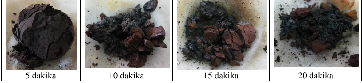
Şekil 8. 199. 15 dk. mekanik aktivasyona tabi tutulmuş karışımdan üretilen kompozit peletlerin 5, 10, 15 ve 20 dk. süreyle sadece vakumlama yapılarak gerçekleştirilen redüksiyon işlemleri sonucunda elde edilen makro görüntüleri
