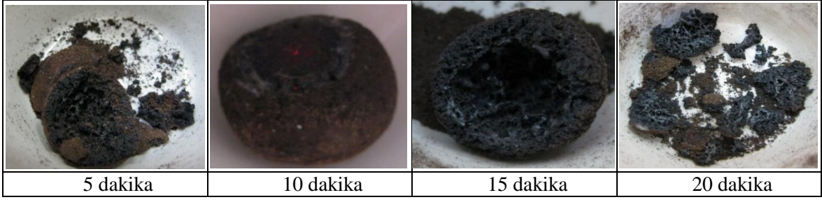
Şekil 8. 82. Redüksiyon süresine bağlı olarak M serisi (B.O:1,2, Sto:4) redüksiyon ürünlerinin makro değişim görüntüleri
