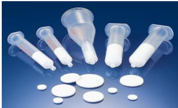
Şekil 2.4 Çeşitli SPE kolonları ve diskleri
