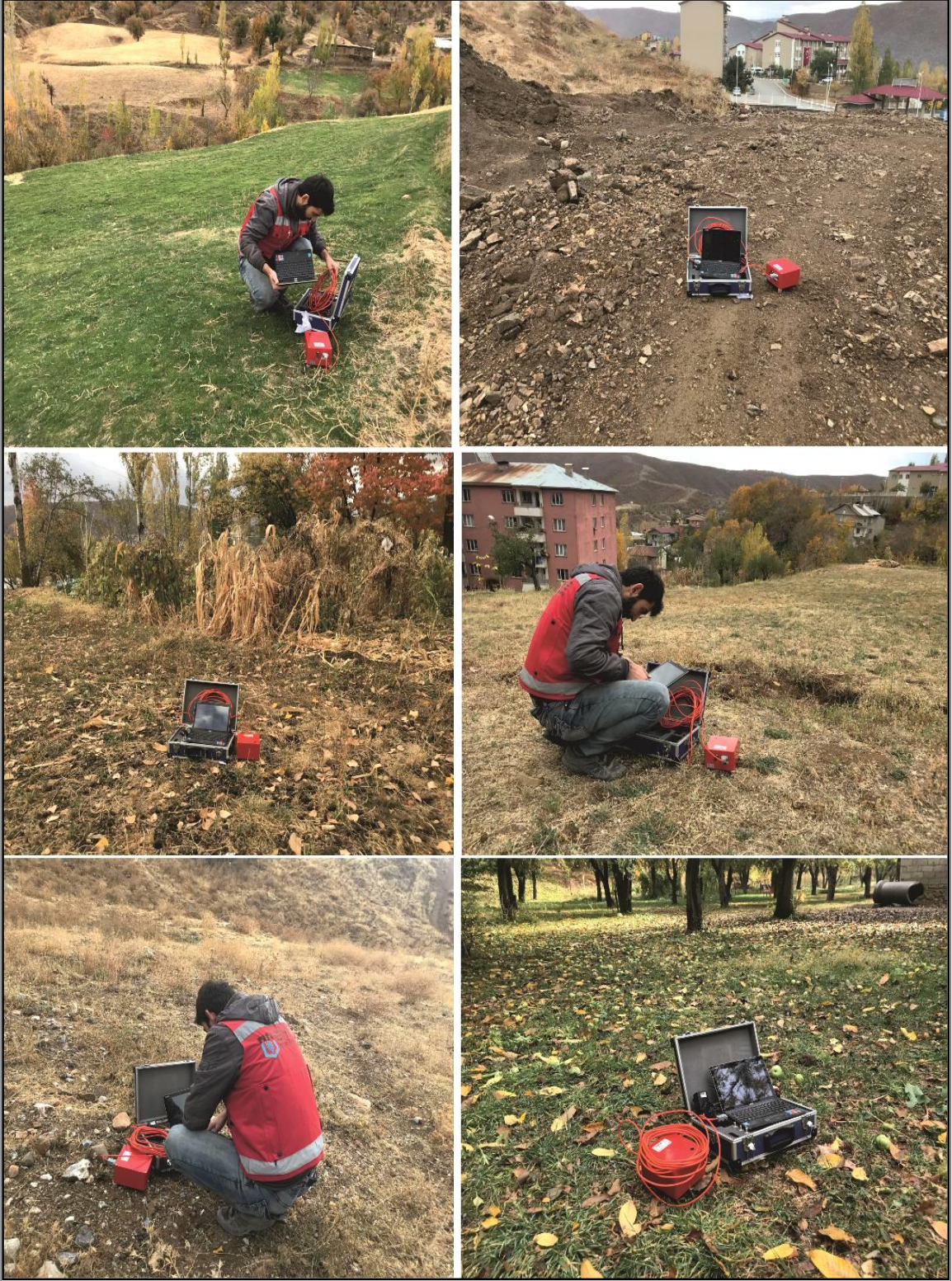
Şekil 3.16. Çalışma alanındaki Mikrotremor çalışmalarından görünümeler
