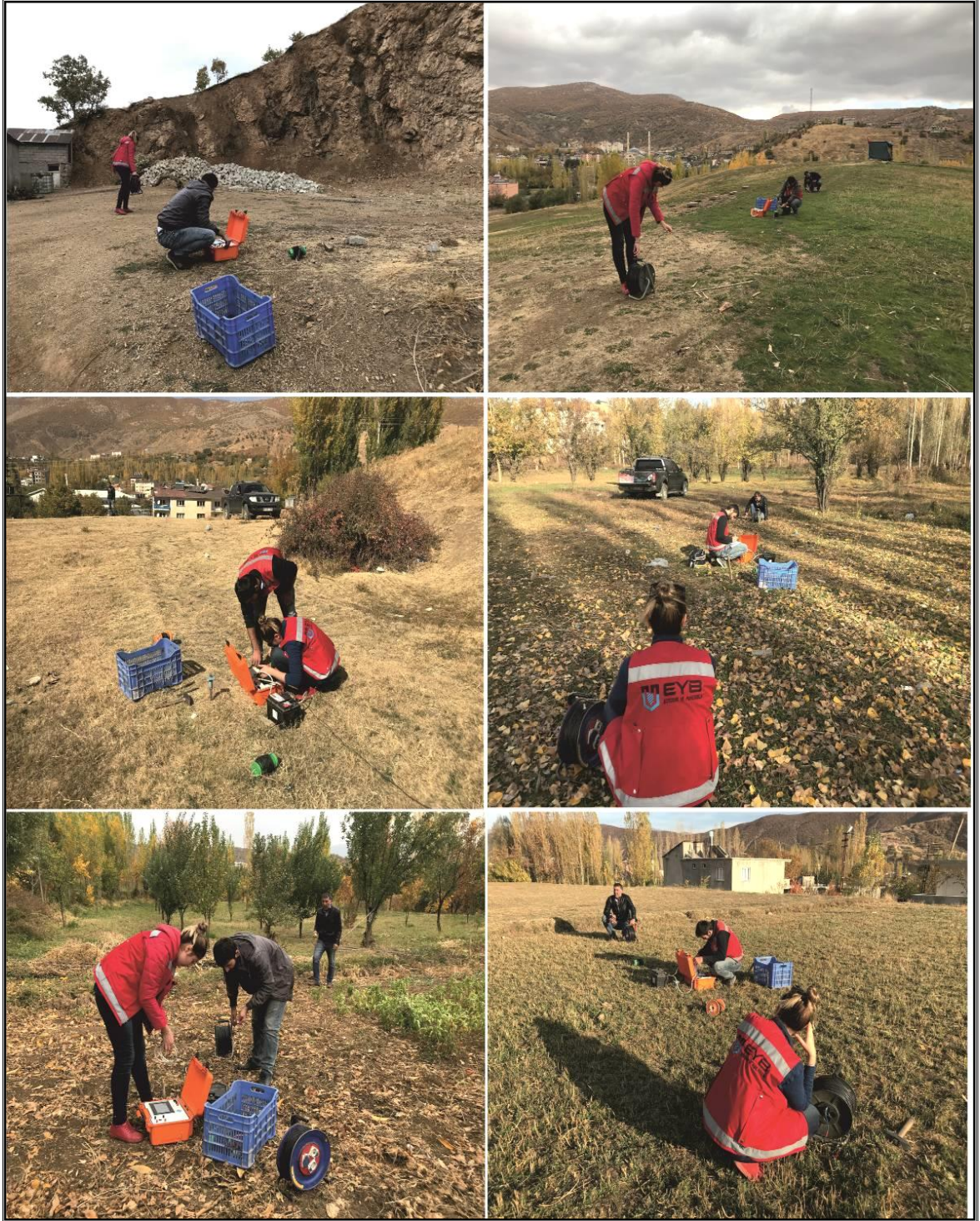
Şekil 3.15. Çalışma alanında yapılan düşey elektrik sondaj yönteminden görünüm
