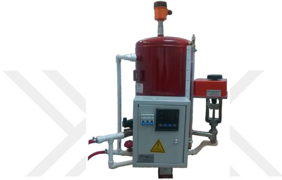
Şekil 4. 2. Sıvı seviye kontrol sistemi
