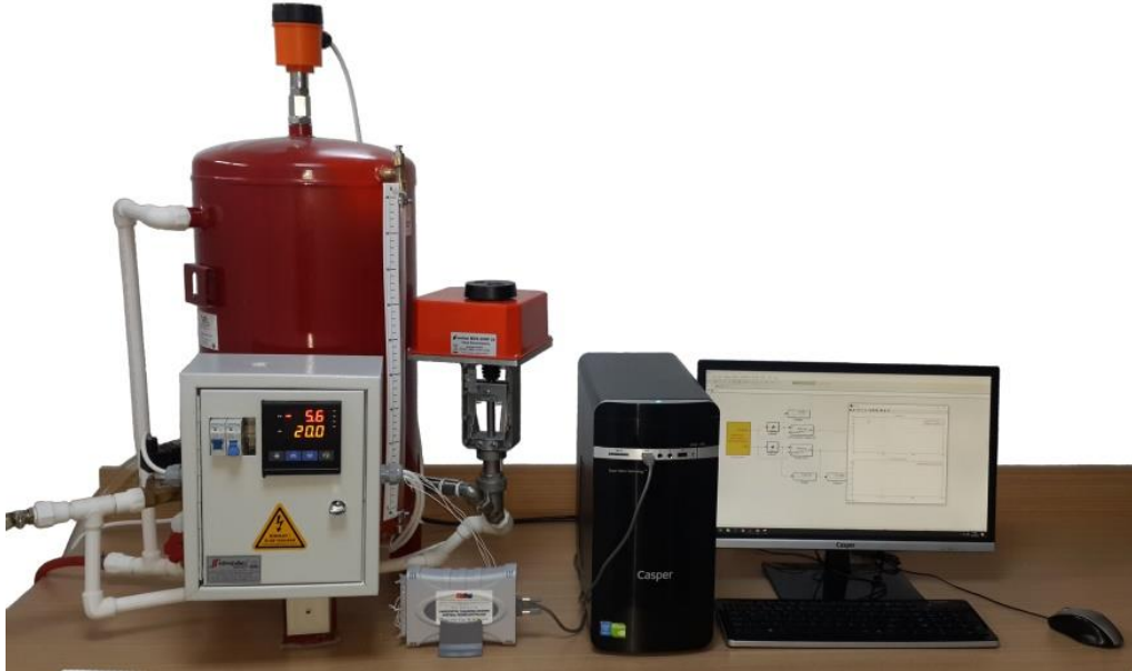
Şekil 4. 22. Sıvı seviye kontrol sistemi
