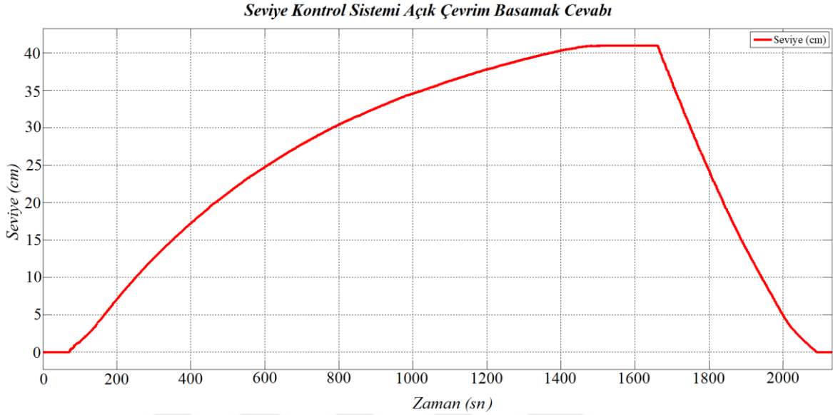
Şekil 4. 14. Şebeke vanasından akan sıvı miktarı yaklaşık 0.1 litre/sn. iken sıvı seviye kontrol sisteminin açık çevrim basamak yanıtı
