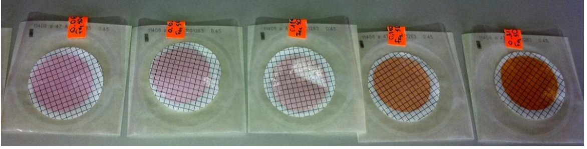
Şekil 6.10. Örnek 2 için pH 7 de kullanılan membranların işlem sonu görüntüsü.
