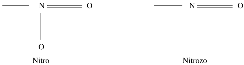
Şekil 2.2. Nitro ve Nitrozo boyarmaddelerinin kimyasal yapısı (Gökkuş, 2006).
