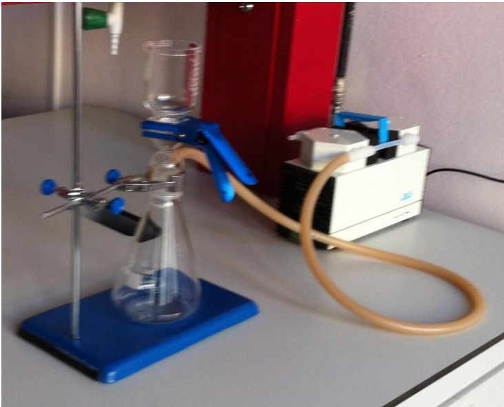
Şekil 5.4. Deneylerde kullanılan membran filtrasyon düzeneği.
