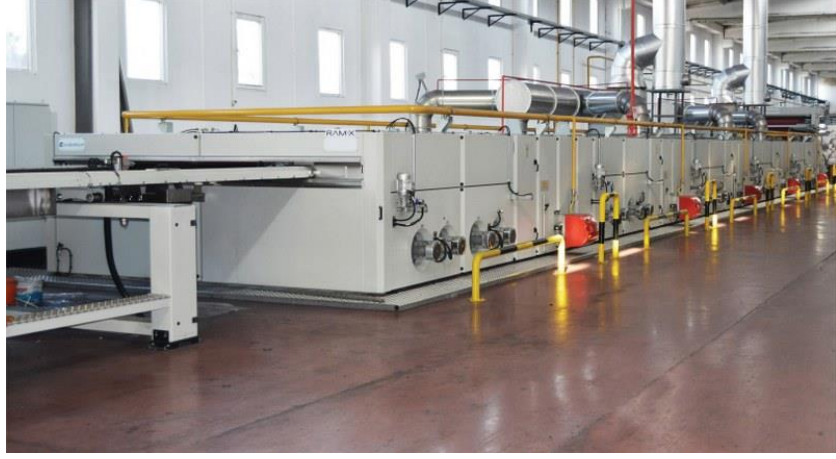
Şekil 7-5 Ekonomizer kurulu bir ramöz makinası
