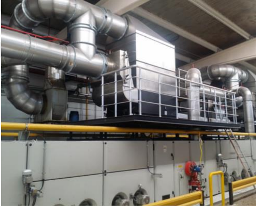
Şekil 7-6 Ramöz makinası üzerinde ekonomizer resmi
