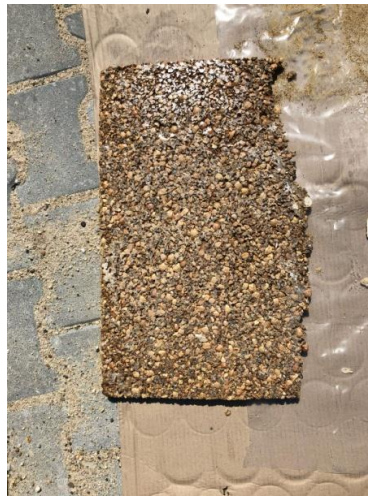
Şekil 5.19. Levhalarda meydana gelen kırılma (Özer, 2018)
