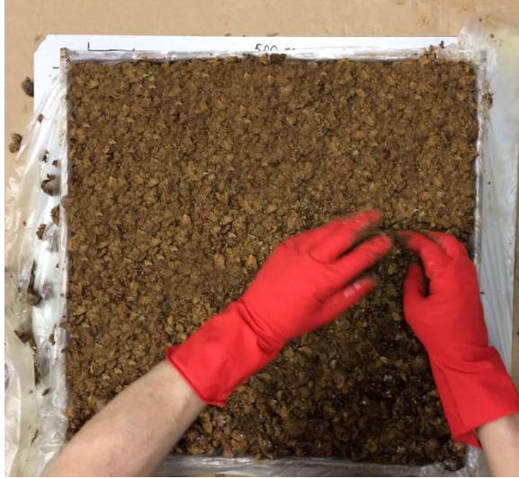
Şekil 5.12. Polivinil asetat tutkallı karışımın çerçeveye aktarılması (Özer, 2018)
