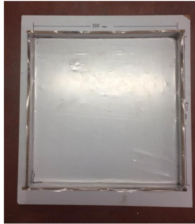
Şekil 5.7. Gerekli numune ölçülerinde hazırlanmış kalıp örneği (Özer, 2018)
