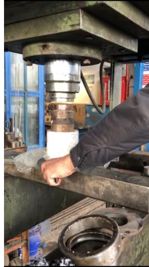
Şekil 5.22. Pres makinesinde basınç uygulanan numune (Özer, 2019)
