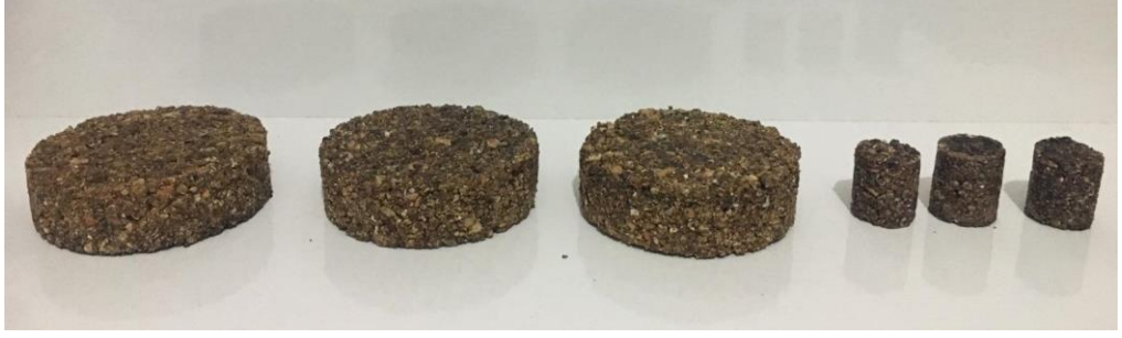
Şekil 5.23. Ses geçiş kaybı ve ses yutma testi için hazırlanan numuneler (Özer, 2019)
