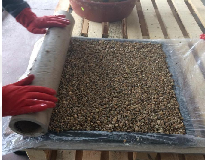
Şekil 5.15. Yapı amaçlı akrilik reçineli karışımın çerçeveye aktarılması
