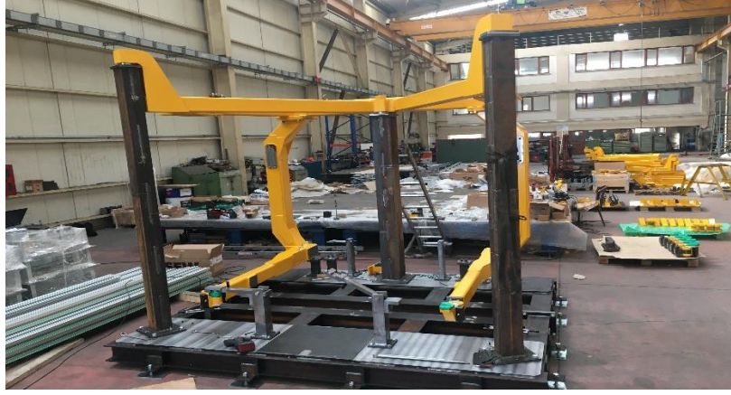
Şekil 3.8. İmal edilmiş fikstür ve lift.
