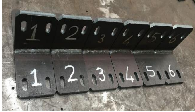
Şekil 5.9. Kaynatılmış braket numuneleri
