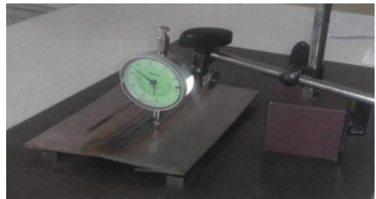
Şekil 2.2. Gharib vd. (2019)'un çalışmasına göre iki klemp konumu arasındaki açısal ve bükülme distorsiyonu.
