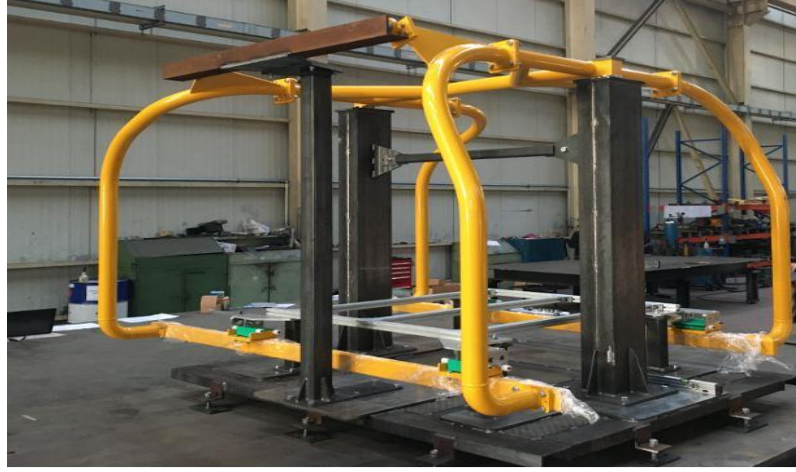
Şekil 3.3. İmal edilmiş fikstür ve askı modeli.
