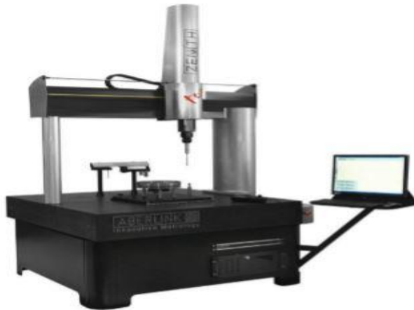
Şekil 4.19. Yiğit (2019)’un çalışmasına göre üç boyutlu ölçüm cihazı (CMM).
