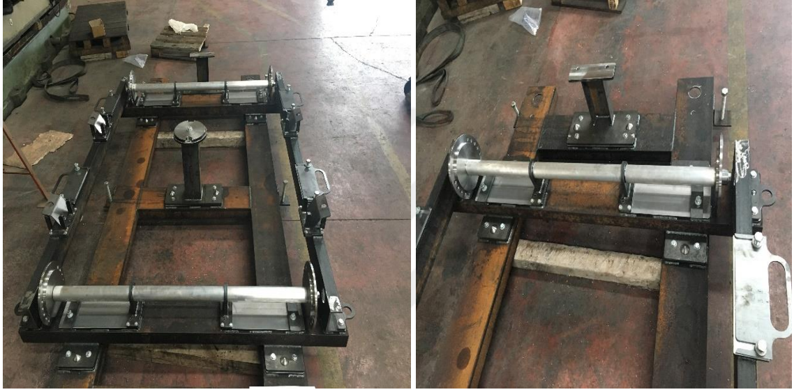
Şekil 3.16. Kaynak esnasında kullanılmak üzere imal edilmiş fikstür.
