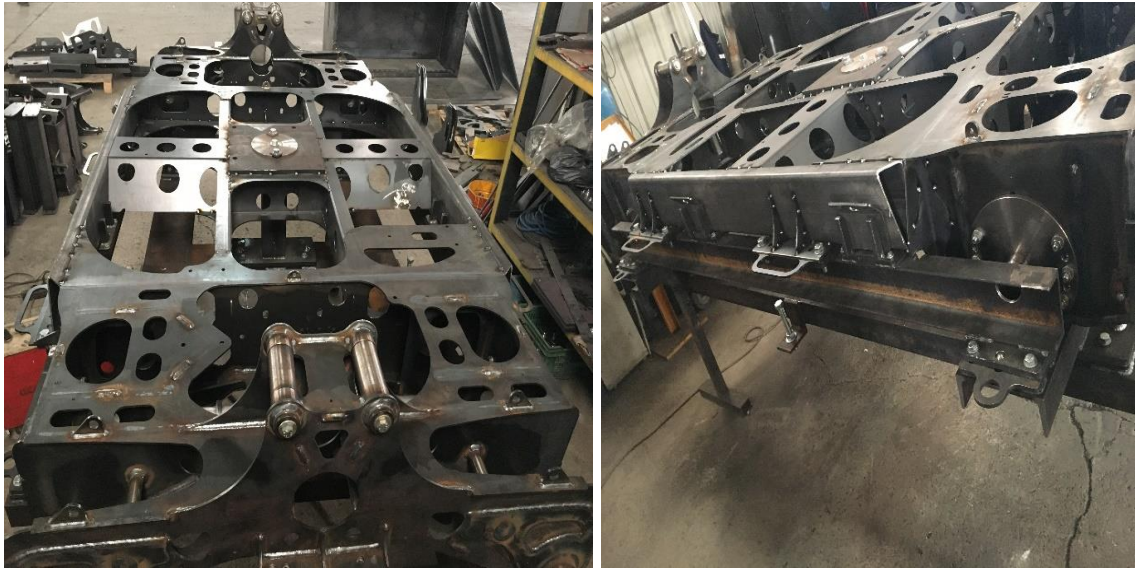
Şekil 3.17. Ürünün fikstür üzerinde kaynağı.
