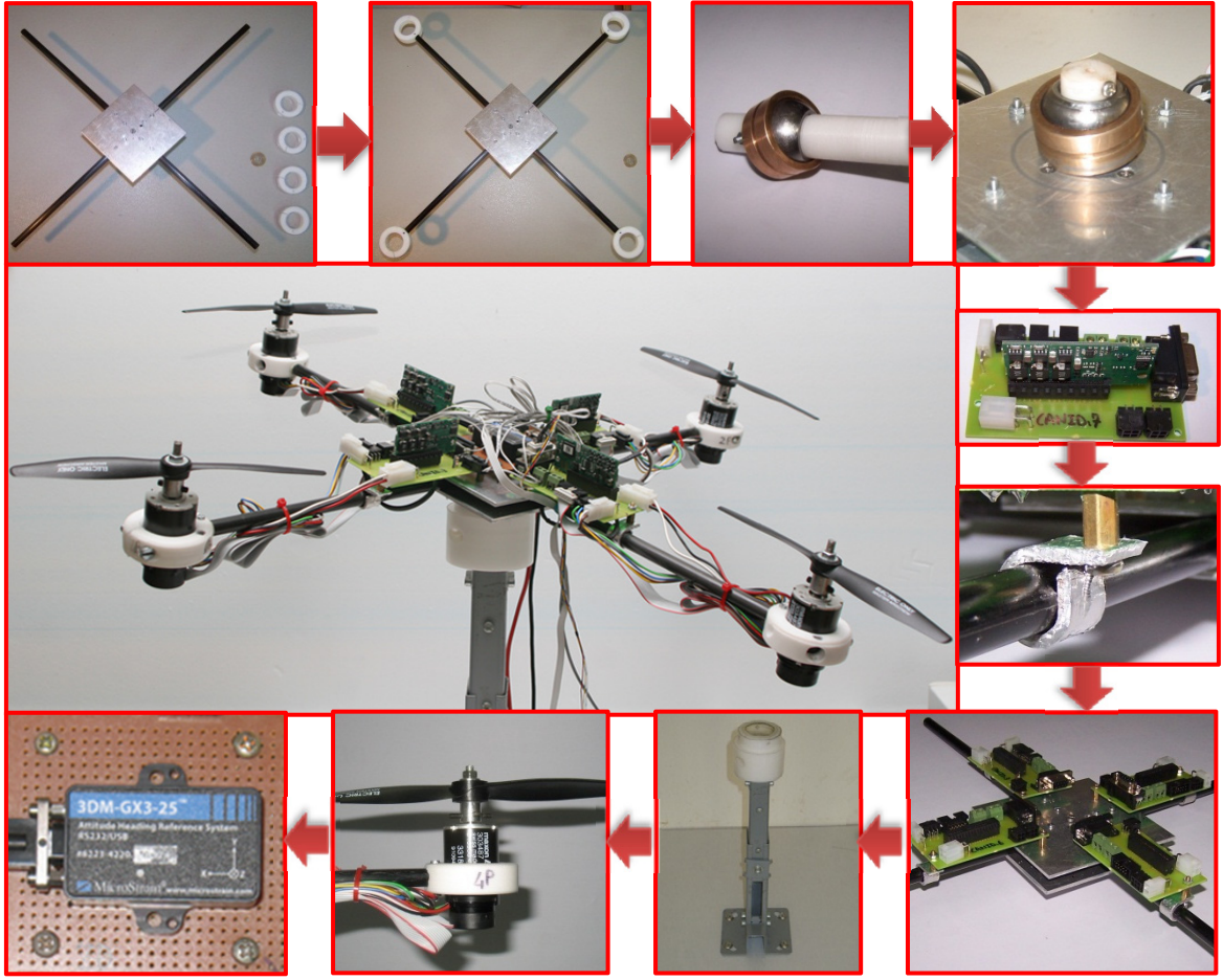
Şekil 3.5 Quadrotor deney düzeneği imalat aşamaları
