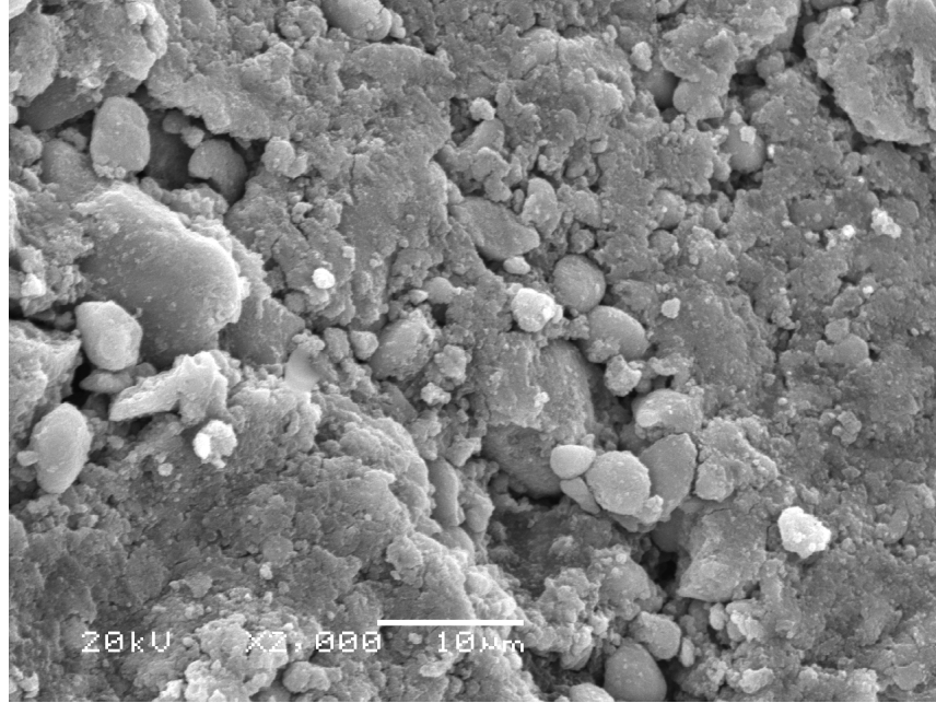
Şekil 4.41 RV1 yüklü manyetik nanopartikül ( Fe_3O_4 ) yüklü T. versicolor biyosorbentinin yüzey görüntüsü
