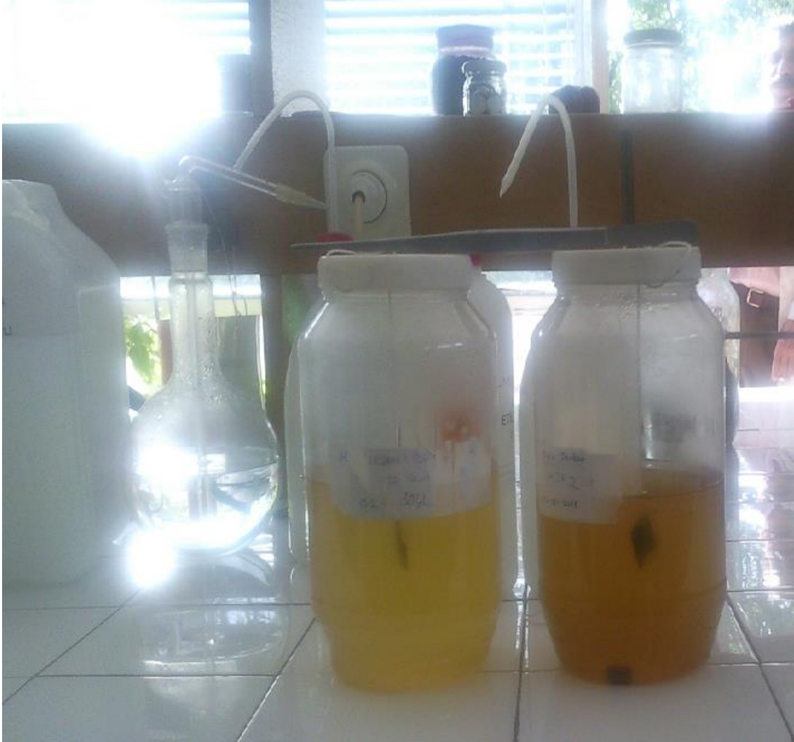
Şekil 4.54. St 37.2 ve 304L kuponlarının ham şerbet içinde 3 gün bekletilmesi sonucunda elde edilen şerbet renkleri.
