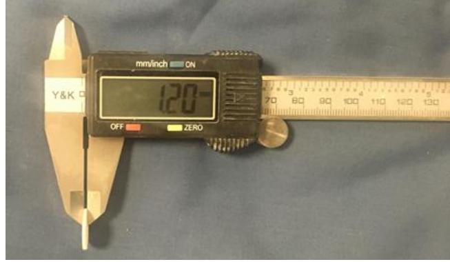
Şekil 3.2. Dijital kumpas ile örnek kalınlıklarının kontrol edilmesi
