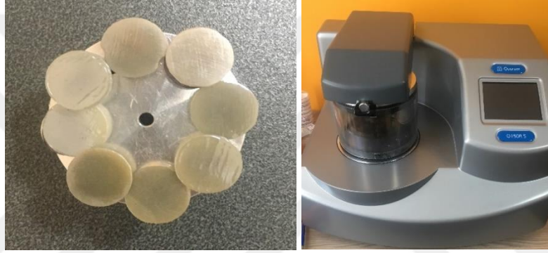
Şekil 3.6. Altın kaplama cihazı ve Altın kaplanmış örnekler
