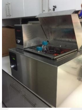
Şekil 3.2. Çalkalayıcı su banyosu
