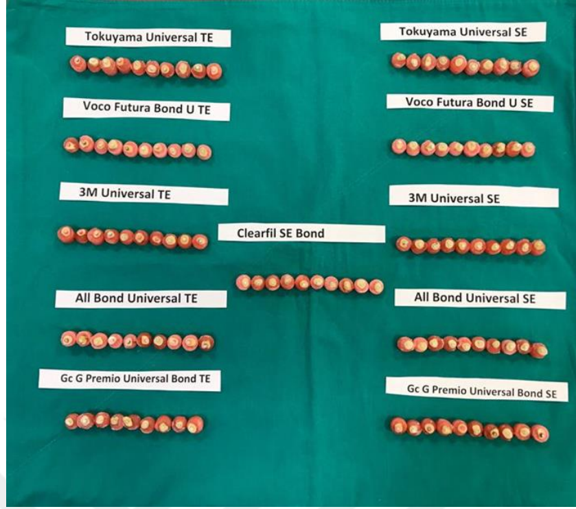
Şekil 3.3. Örneklerin makaslama testinden önceki gruplara göre dizilmiş hali
