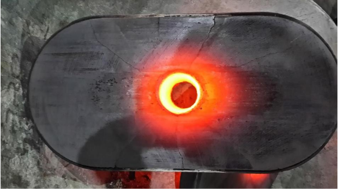
Şekil 6.39. 5 Döküm kullanım sonrası potadan devre dışı kaldığı durumu
