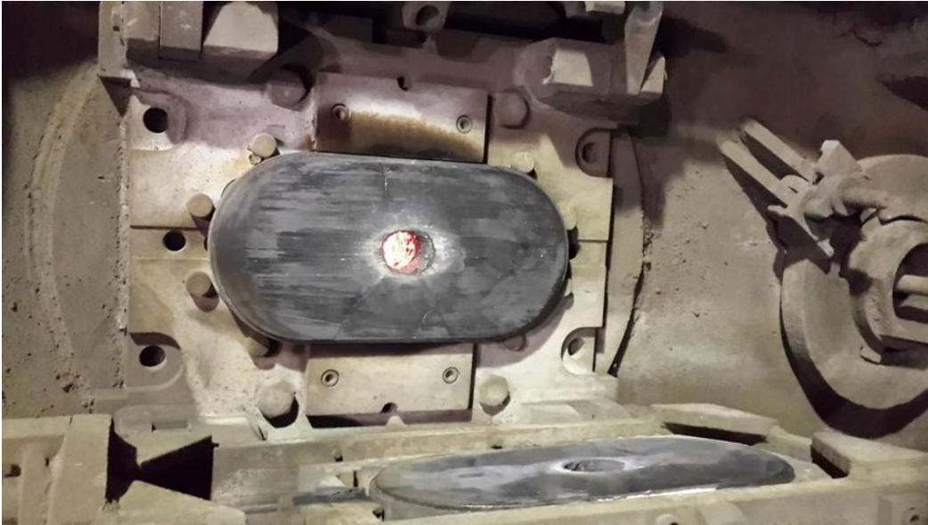
Şekil 6.41. Pota hazırlama bölümünde döküm sonrası plakanın kontrol edilmesi
