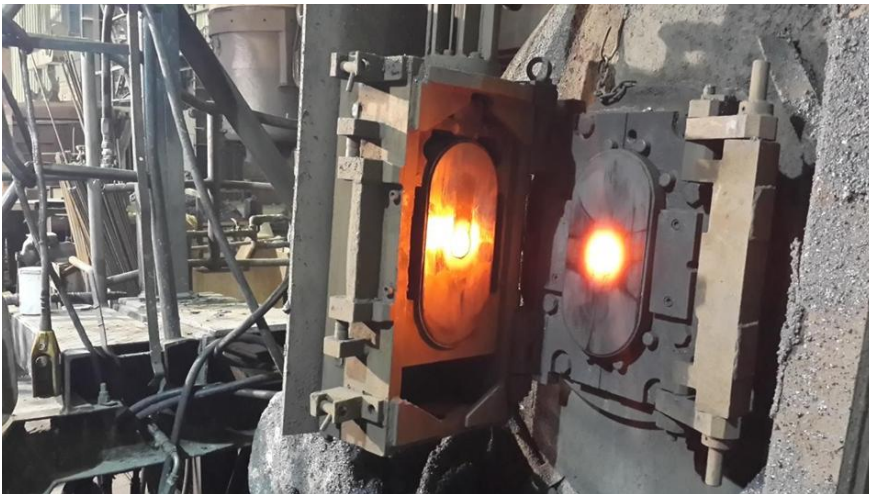
Şekil 6.44. Gelen potadan plaka sökülmeden önceki durumu
