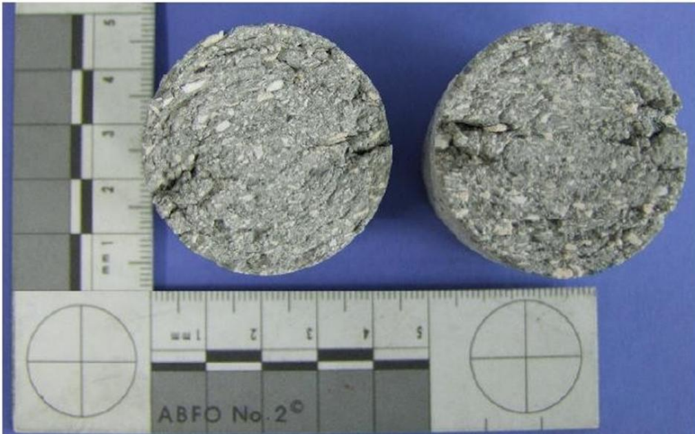
Şekil 6.23. Reçete 2'nin oksidasyon testi sonrası görüntüsü
