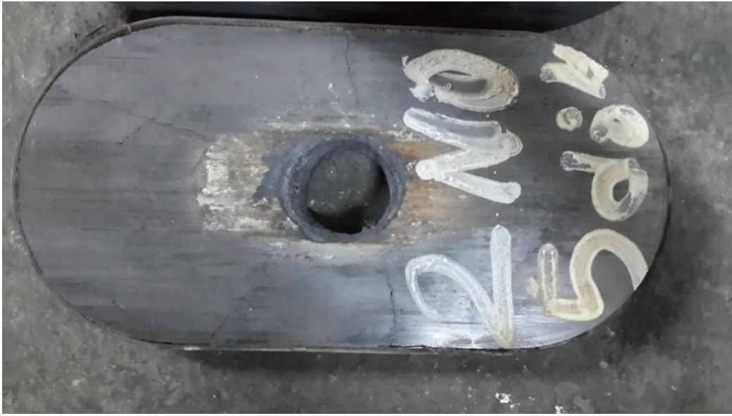
Şekil 6.37. 5 Döküm kullanım sonrası sökülme hareketli (alt) plaka
