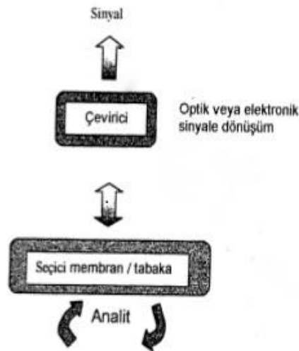
Şekil 2.3. Bir sensörün çalışma mekanizması.
