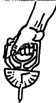
Şekil 6 : El Dinamometresi ile Pençe Kuvvetinin Ölçülmesi
