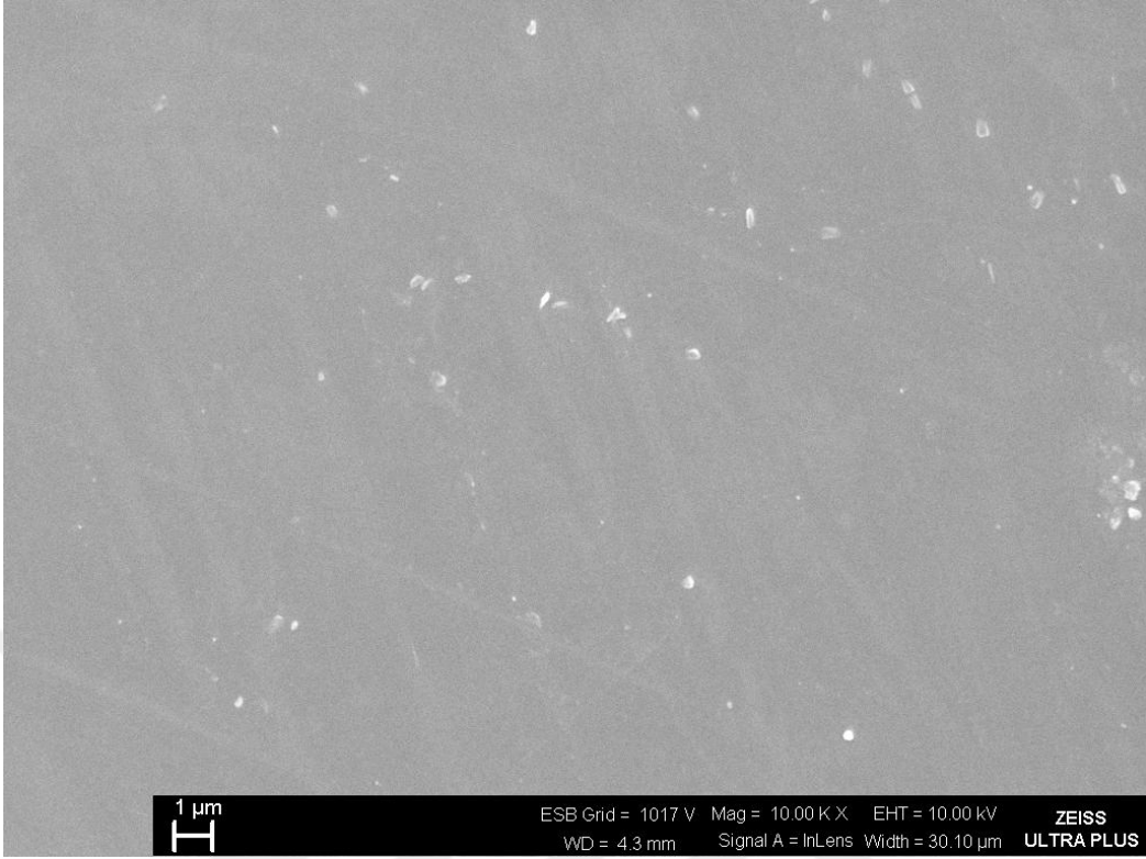
Şekil 7.29. Antirefle kaplama yapılmış L2 numaralı lamelin 10.000 büyütmede FESEM Görüntüsü
