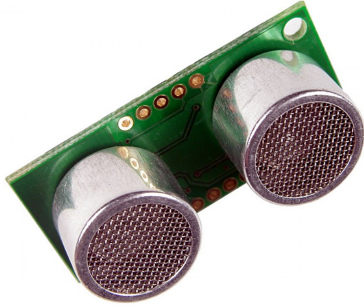
Şekil 6.9 SRF04 Ultrasonik Mesafe Sensörü
