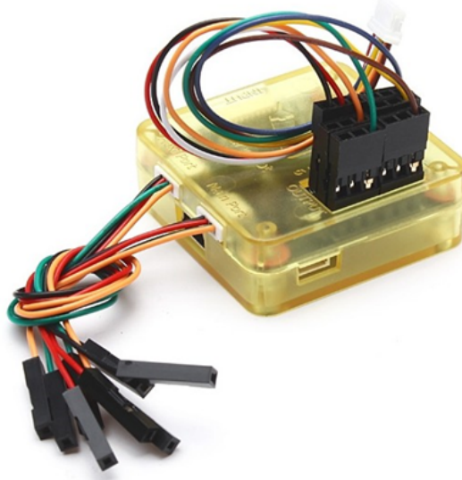
Şekil 6.6 CC3D Multikopter Kontrol Kart Modülü
