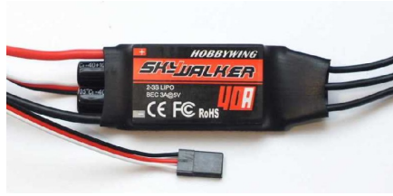
Şekil 6.4 40A ESC Fırçasız Motor Sürücüsü
