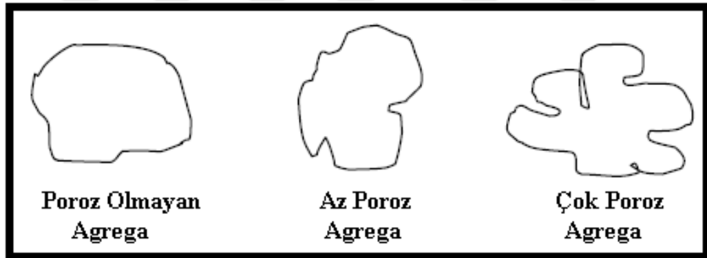
Şekil 3.3 Agregalarda porozite çeşitleri
