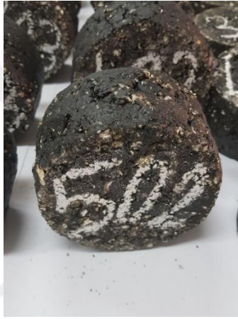
Şekil 6.60 Dinamik ve statik sünme deneyleri sonrası numuneler
