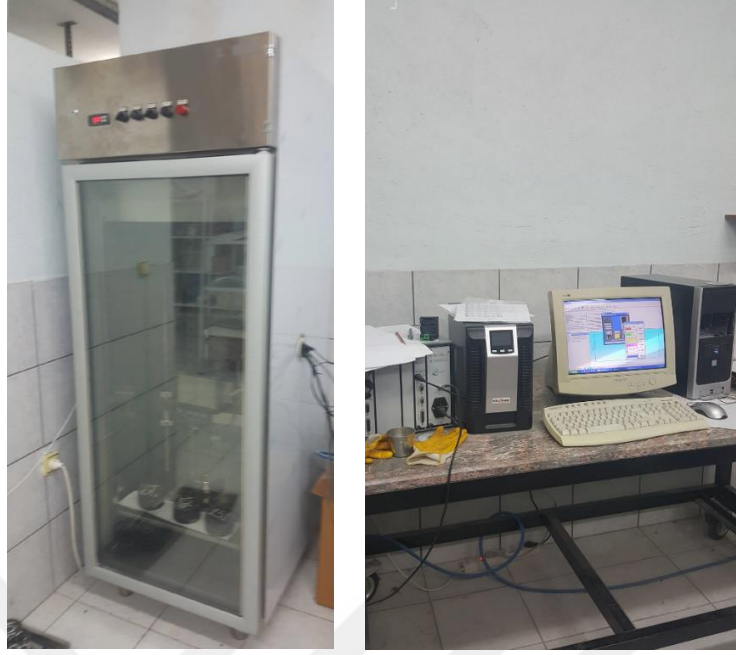
Şekil 6.59 İklimlendirme kabini, güç kaynağı, veri işlemci, bilgisayar
