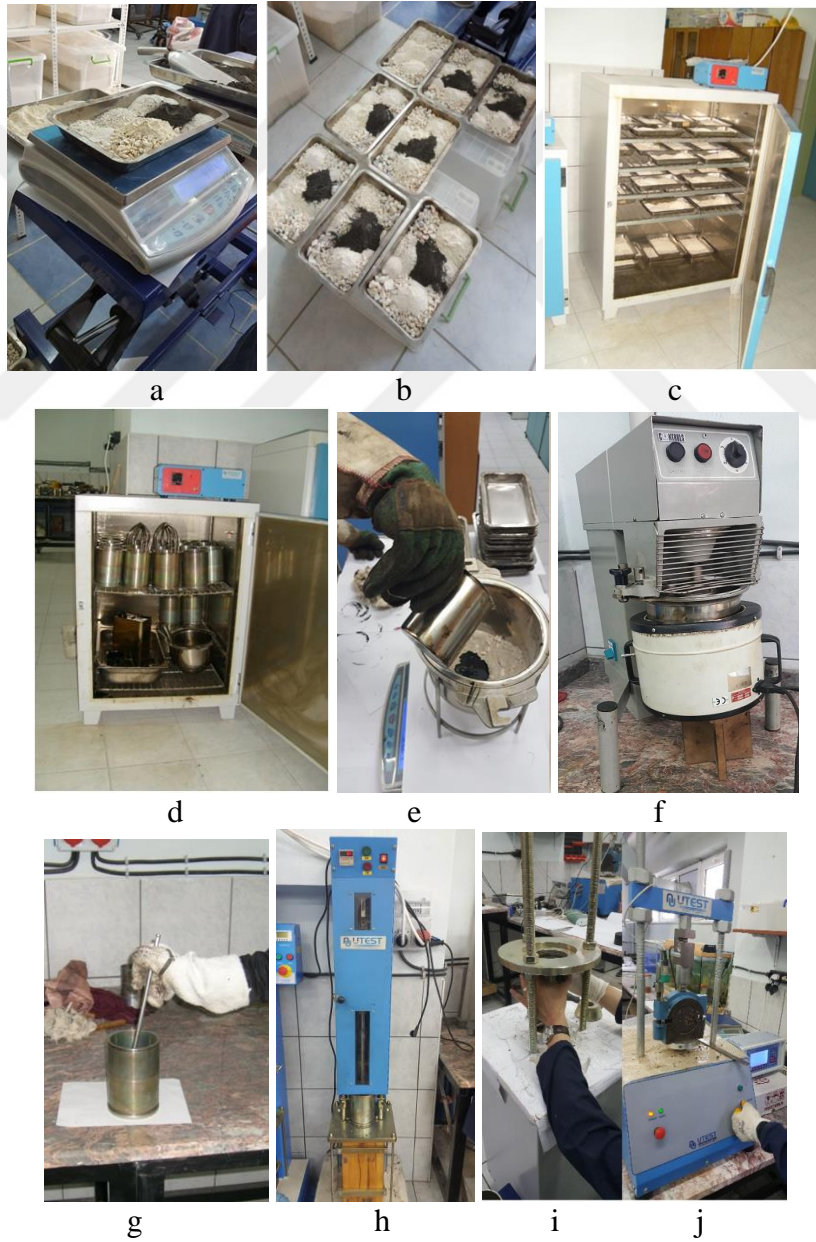
Şekil 6.19.b Numunelerin stabilite ve akmasının ölçülmesi
