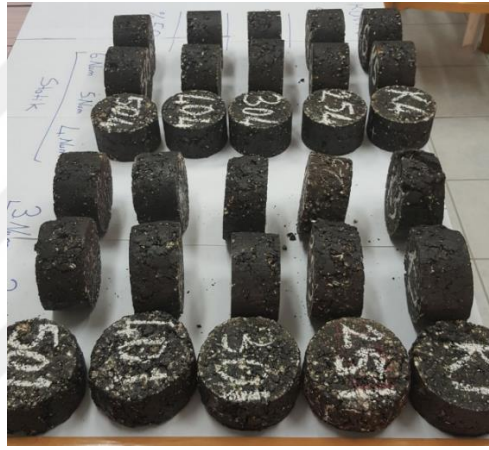
Şekil 6.60 Dinamik ve statik sünme deneyleri sonrası numuneler
