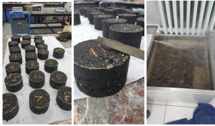
Şekil 6.19.a Numunelerin stabilite ve akmasının ölçülmesi
