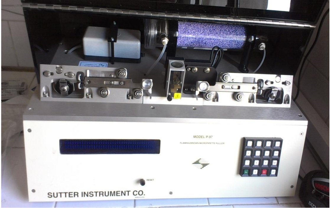
Şekil 4.3 Mikroelektrodların üretiminde kullanılan pipet çekici (puller).
